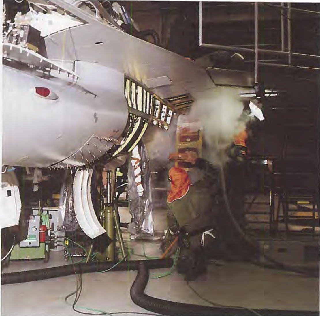
Nedkøling af sidepaneler på F-16 i forbindelse med afmontering. Foto: ASH/KRI
