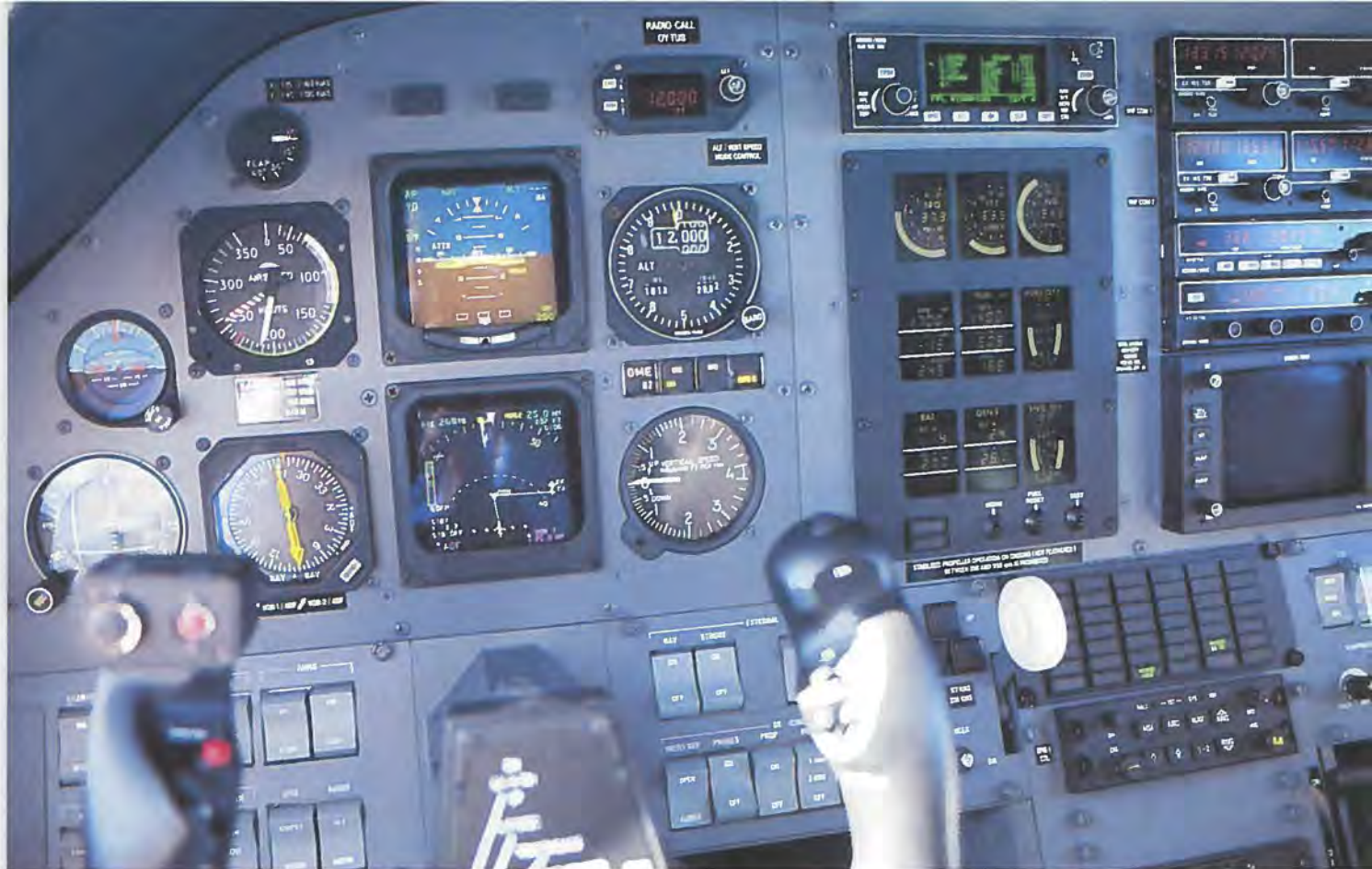
Instrumentpanel i venstre side. Til venstre flyveinstrumenterne, i midten øverst med grøn skrift GPS'en og nedenunder motorindstillinger, propelomdrejninger, udendørstemperatur mv.
