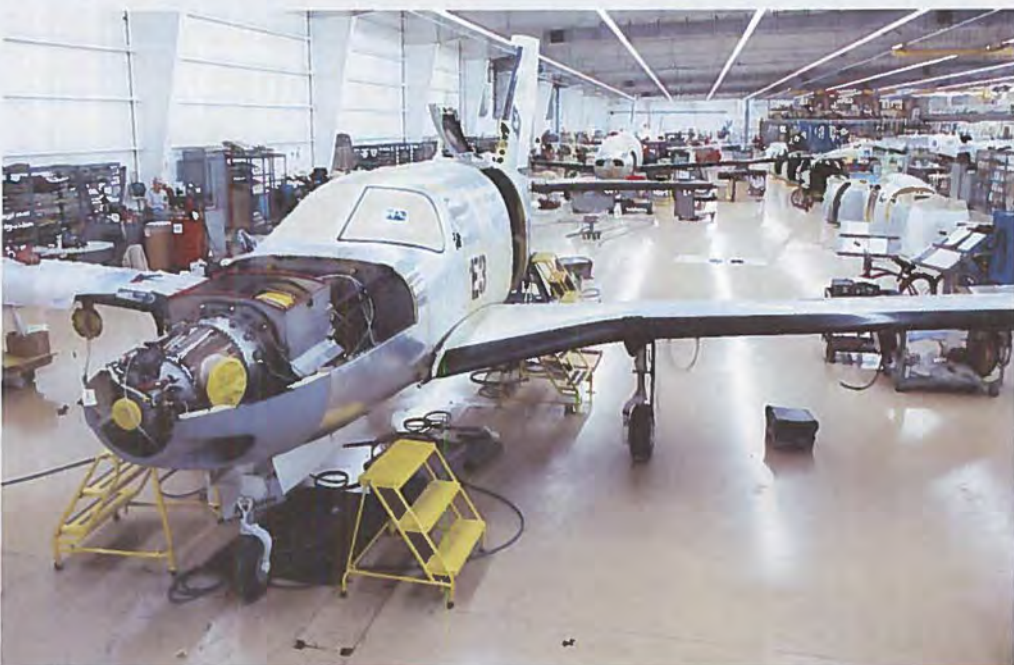
Prototype E-3 med Pratt & Whitney PT6A-motoren monteret skal sammen med de to andre i monteringskolonnen deltage i prøveflyvningerne fra starten af juli måned i Vero Beach.
