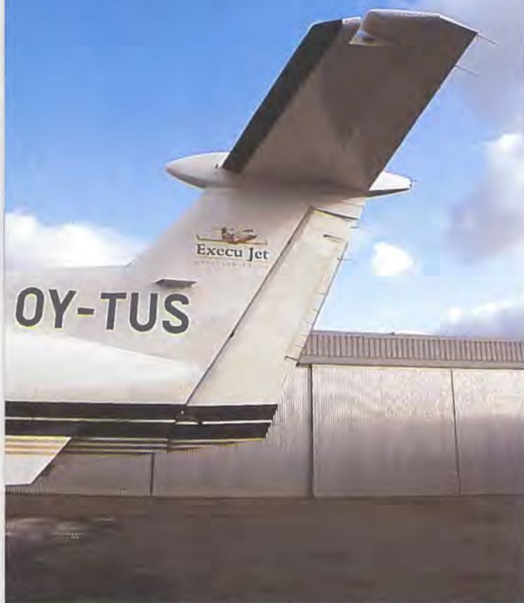
Højderoret sidder ca. fire meter oppe.
