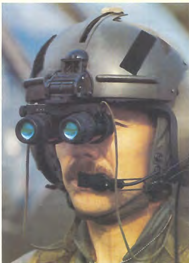
Pilot med NVG monteret på sin hjelm. Synsfeltet med NVG begrænses til 40 grader.
