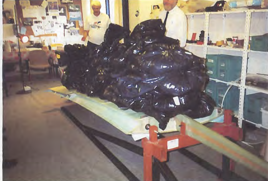
Vingen med fuld belastning – den har nået en nedbøjning på 35,2 cm ved tippen. I baggrunden står kontrollanten Niels Christian Jørgensen og checker opspændingen af vingen. Karsten Hansen afventer testens afslutning.
