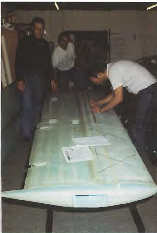
Venstre vinge spændt op i prøvestanden. Bjarne Jensen t.h. er i gang med at markere anbringelsespunkterne for de mange sandsække. Til venstre Michael Willumsen, og i baggrunden Christen Kristensen, der stod for bygningen af prøvestanden.
