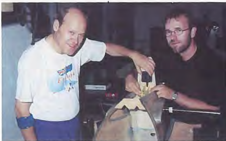
Jens Ole Willumsen og Bjarne Jensen med servotrim og tilhørende justeringsbeslag til højderoret.
