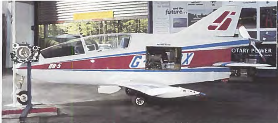
Mid West Engines udstillede denne Bede BD-5 med motor efter Wankel-princippet.
