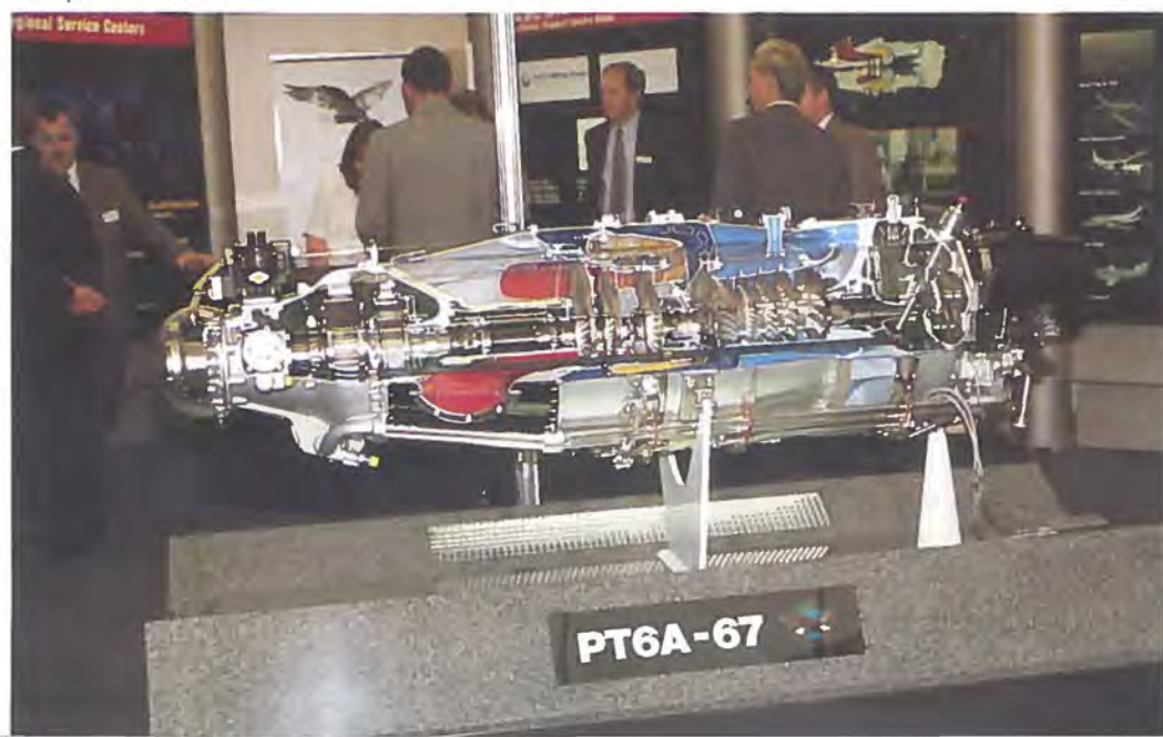
Den gennemskårne PT6A-motor. Luftindtaget er i højre side ved nettet. Propellen monteres i venstre side på billedet.
