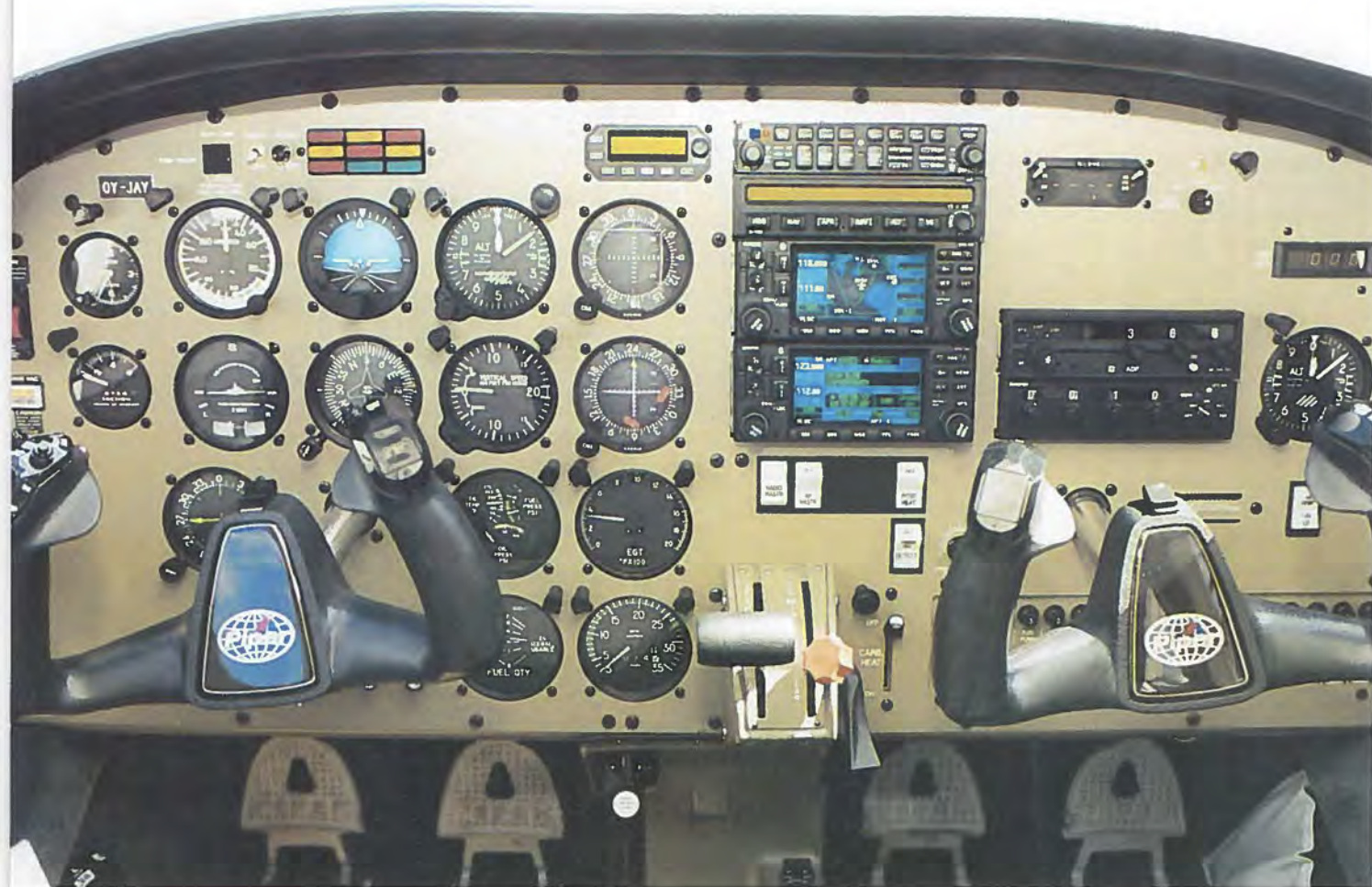
Instrumentpanelet i OY-JAY. Ovenover de to GNS 430 ses autopilotens kontrolpanel, derover intercompanelet og til venstre herfor højde-/stige-forvalgsvælgeren.
