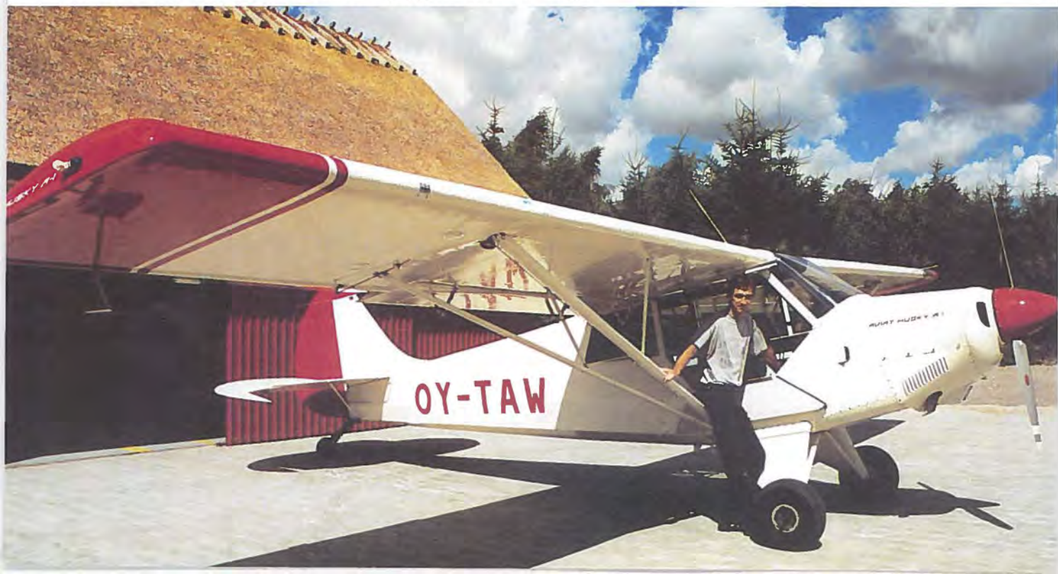
180 hk og indstillelig propel er med til at give overlegne kortbaneprestationer.
