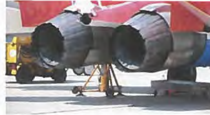
Udblæsningsdyserne kan bevæges både op-ned og højre-venstre.
