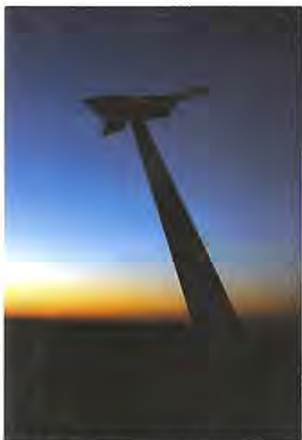
X-47B på »pæl« på Lockheed Martin Helendale Measurement Facility, Calif. Det føreløse flys »usynlighed« på radarskærme skal testes hele næste år. (Foto: Boeing).
