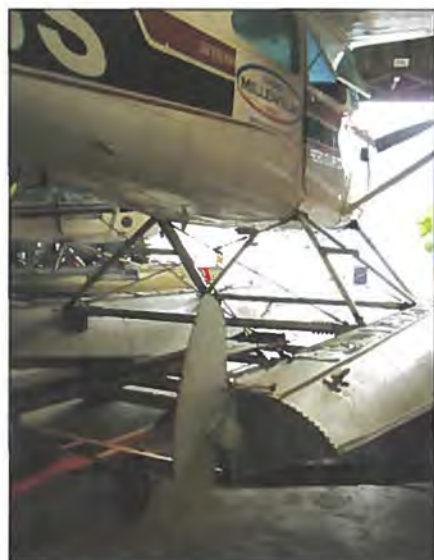
Bagtil på pontonerne er vandrorene placeret. Man styrer dem med pedalerne, man trækker dem op af vandet fx ved hurtig taxi og take off.
