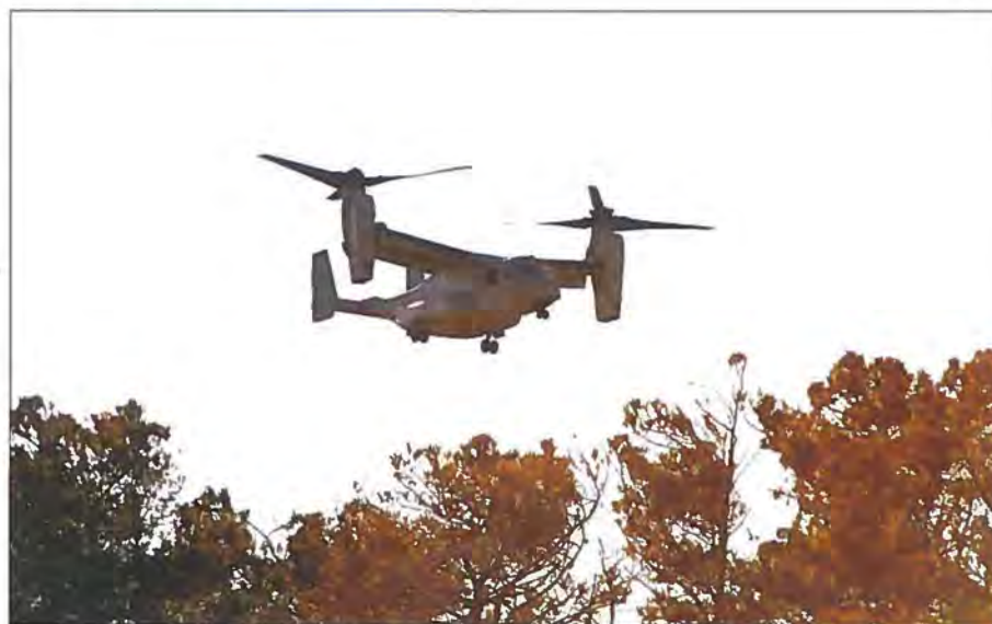
De to foto viser V-22 Osprey under flyvning som fly (motorerne vandret – propeller lodret) og som helikopter (i hover) med motorerne lodret og rotererne vandret. Foto: Knud Larsen
