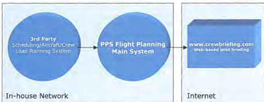
Skemaet illustrerer data-flow'et i PPS-systemet.
