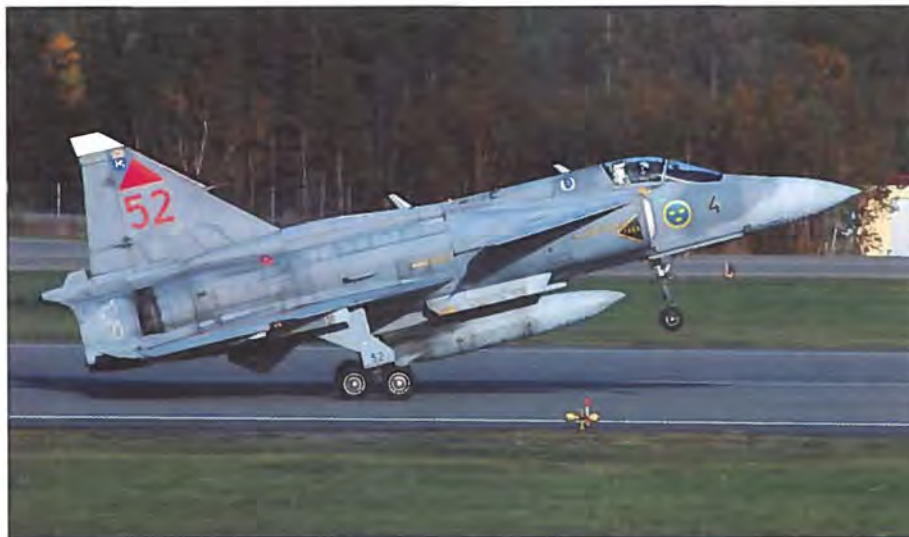
Det kraftige understel er også beregnet til ujævne veje.
