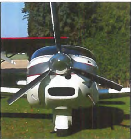
Den trebladede propel bliver trukket af en Rotax 914 på 115 hk.
