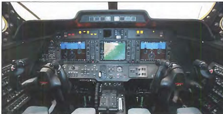
Cockpittet i HondaJet med tre fladskærme, som efterhånden er standard i mange fly.
