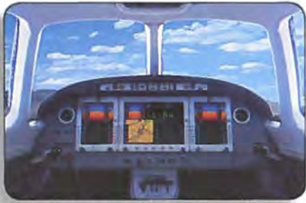
Instrumentpanelet i Eclipse Aviation 500, hvor den virtuelle andenpilot er programmeret til en række funktioner. FOTO ECLIPSE AVIATION.
