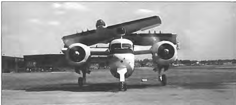
Med foldede vinger fylder Tracker blot godt otte meter i spændvidde.
