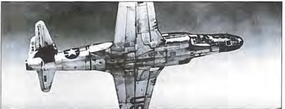
Det amerikanske flyvevåben ønskede at benytte ubevæbnede Shooting Stars udstyret som foto-fly. Her ses en sådan RF-80C med den specielle foto-næse.
