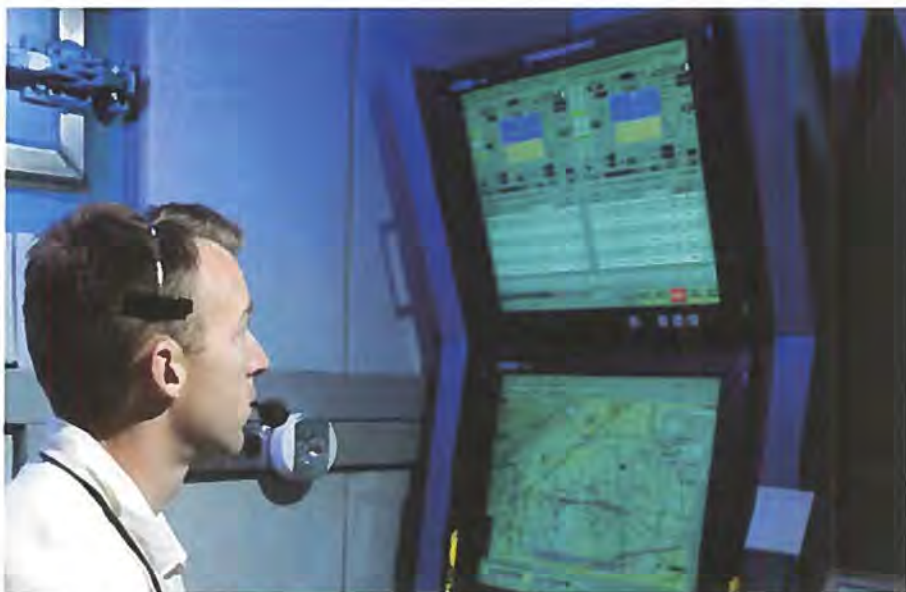
En vigtig del af J-UCAV X-45A udstyret er kontrolvognen på jorden, hvor »piloten« overvåger det ubemandede luftfartøjs bevægelser. (Foto: Boeing).
