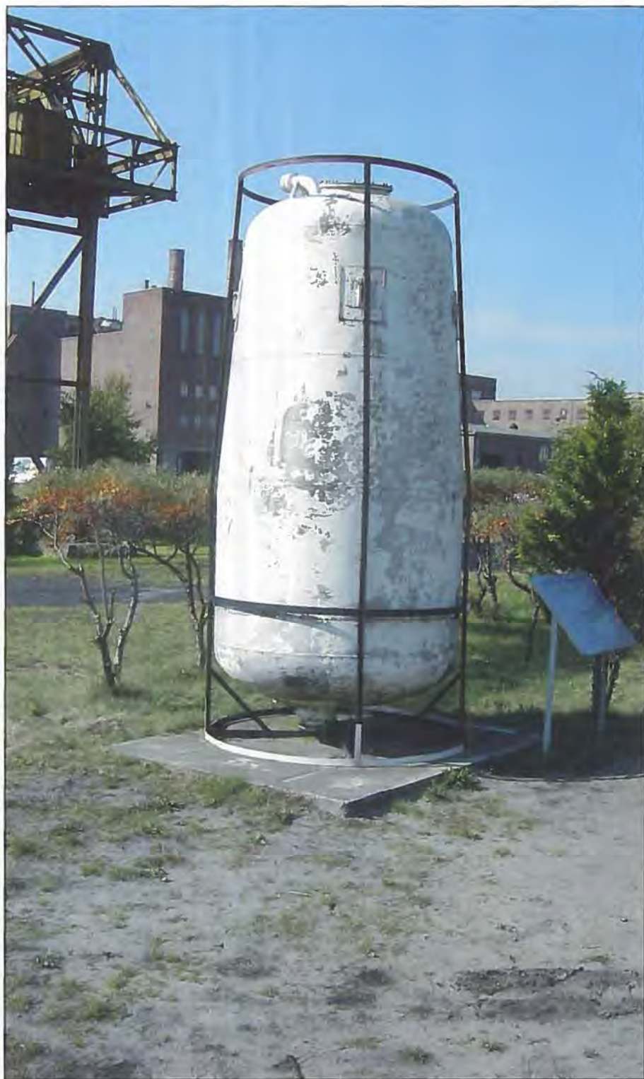
Tank til flydende ilt. Tanken blev fremstillet af metalvarefabrikken "Austria" i Wien i 1944. Efter krigen endte den i det nordlige Østrig, hvor den i mange år blev anvendt som kornsilo. Tankens vægge er 1,2 til 2,0 mm tykke og fremstillet af en legering af aluminium og magnesium, og den vejer kun 70 kg.
