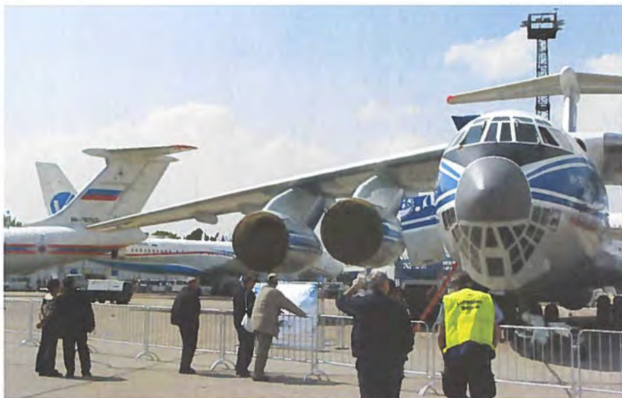
Den nye version af Il-76 hedder Il-76TD-90VD. Den har fået nye motorer på hver 32.000 pounds tryk, nyt kommunikations- og navigationsudstyr samt godkendelse til en lastevne på 50 tons. Længde: 47 m, spændvidde: 50 m og højde til haleplanet: 15 m. Se også forsidefoto.
