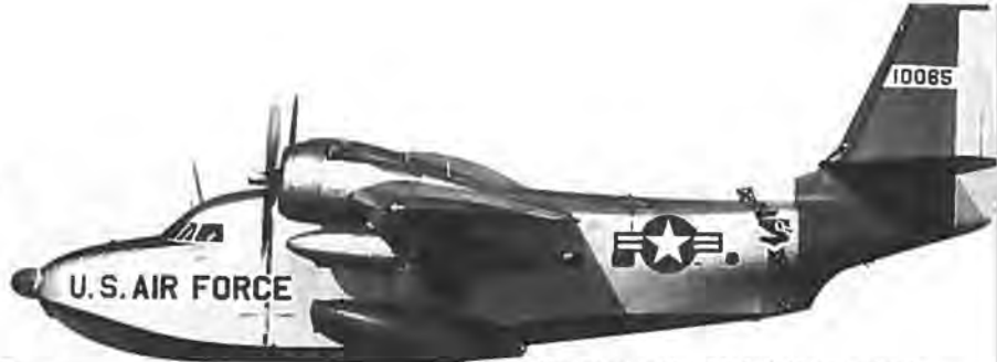
Grumman SA-16 Albatross med ekstratanke under vingerne og brændstof i pontonerne gav imponerende rækkevidde for det smukke fly.
