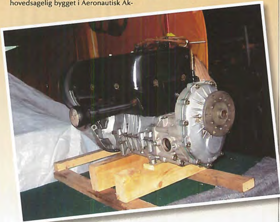
Motoren som skal indbygges i Projekt Ellehammer 2006 er en to-cylindret, 500 ccm Rotax 503 på 46 hk med gearkasse. Den har to karburatorer.
