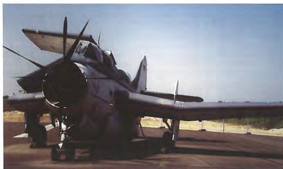
Gannet kan naturligvis »folde vingerne« for at kunne gebærde sig på et hangarskib. Her er det en tysk Gannet – udstillet på Luftwaffemuseet i Berlin – der i mangel af hangarskibsomgivelser meget instruktivt viser de besøgende hvor lidt en Gannet kan fylde.
