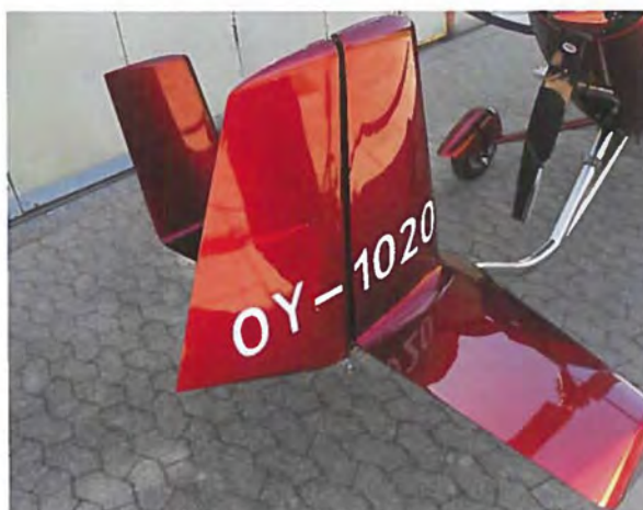
Et stort og bredt haleror holder styr på de sideværts bevægelser.
