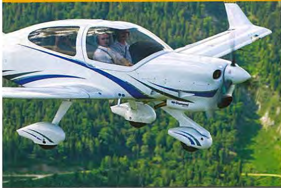
Uer man helt ned til 35 % power cruiser den bedede DA40 NG alligevel med godt 90 kt og d et forbrug på 12-13 liter i timen.
