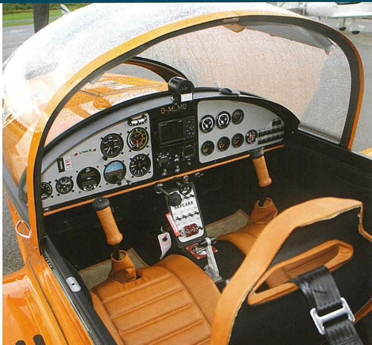
Interiøret har en række utraditionelle løsninger, bl.a. skal man trykke fremad på håndtaget til hjulbremserne.
