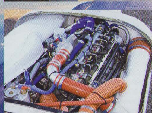
Centurion 2,0-motoren passer under den eksisterende cowling. Bemærk ladeluftkøler tv. og common rail-indsprøjtningssystem i midten.
