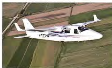
Tecnam 2006T har 2 Rotax 912-motorer og er et yderst økonomisk twin-alternativ.
