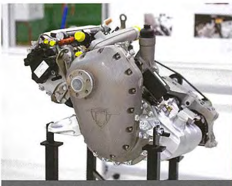
Austro Engine AE-300 komplet med gearkasse fra HörTechnologie.
