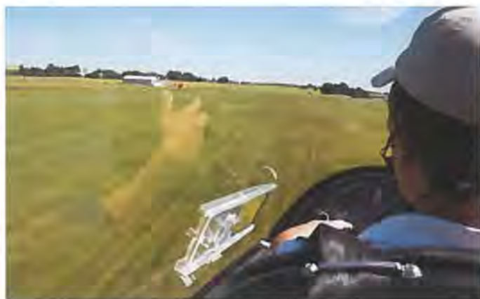
Take off fra Ringsted. Rotoren kører ca. 350 O/min. Ved maksimal startvægt stiger maskinen med 700 ft./min.
