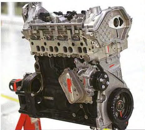
Austro Engines AE-300-E4-motor er bygget over denne Mercedes motorblok. Den hedder oprindeligt OM 640 og er konstrueret til modellen A 200 CDI, hvor den har 140 hk og 300 Nm.
