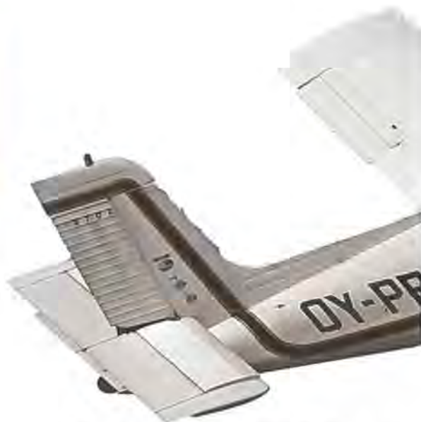
Rallye kendes let på halen og det store drivhuscockpit. Jes har fået indstillet propellen med relativ lav stigning, så den trækker godt igennem ved lav fart. Vigtigt ved STOL-starter på improviserede baner. Foto: Jonas Svenstrup
