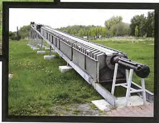
Grundet de smalle vinger stallede V1 ved 580 km/t. En gigantisk dampkatalpult sørgede for flyvefart på få meter. Også i de bemandede udgaver!
