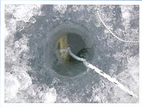
Sikring af fly med et hul i isen og en pind på tværs. Det er low-tech, men det virker.
