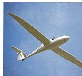
15-meter-vingerne er hentet direkte fra motorsvæveflyet Sinus og giver flyet et glide-tal på 1:41. ▼
