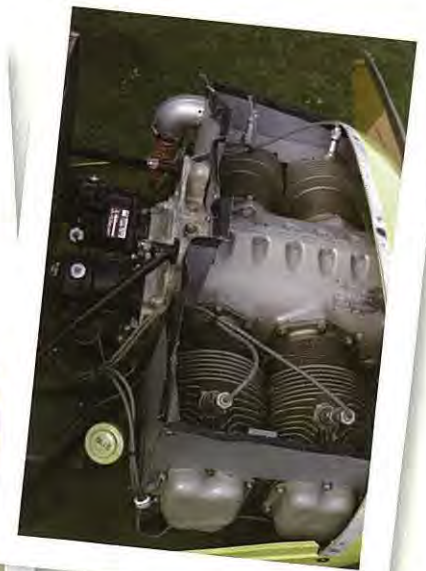
Den trofaste Continental-motor bruger 16 liter benzin i timen.
