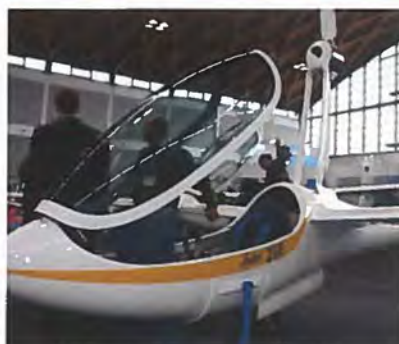
Antares 23E – E for elektro. Antares fra Lange Aviation er selvstartende på eldrift. Det er baseret på Antares 20E, men har længere vinger. Flyet er i øvrigt udviklet i samarbejde med Schempp-Hirth, og deler derfor vinger med den også nye selvstartende Schempp-Hirth Quintus M, der dog har en benzinmotor med benzinindsprøjtning.
