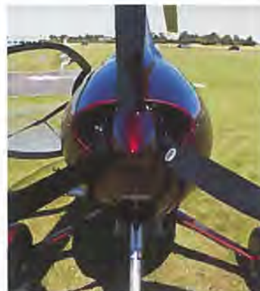
Den tre-bladede hvoprop trækkes af den allestedsnærværende Rotax 912 ULS på 100 hk.
