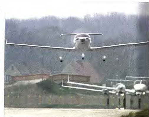
Nu får Diamond DA50, der her ses på sin jomfruflyvning, en større dieselmotor med 280 hk for at give den bedre kort på hånden i forhold til den dominerende Cirrus SR22.
