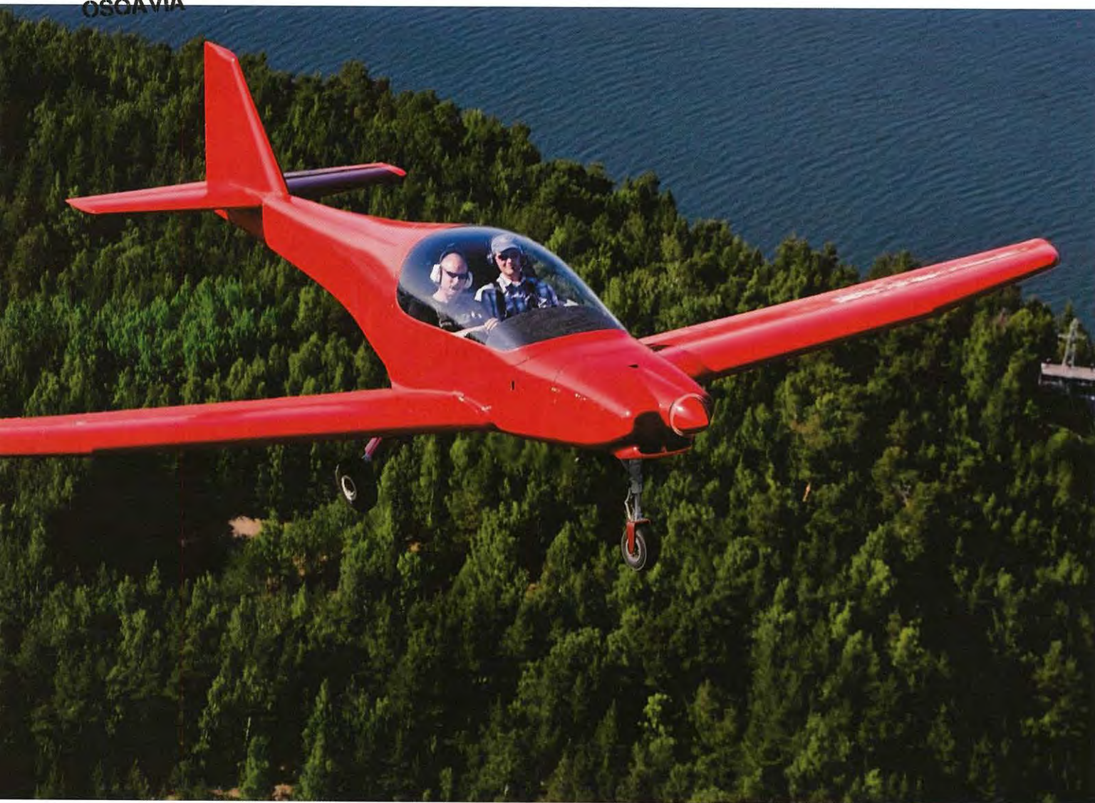
Osqavia-prototypen er et hurtigt fly. Cruisehastigheden er 235 km/t.
