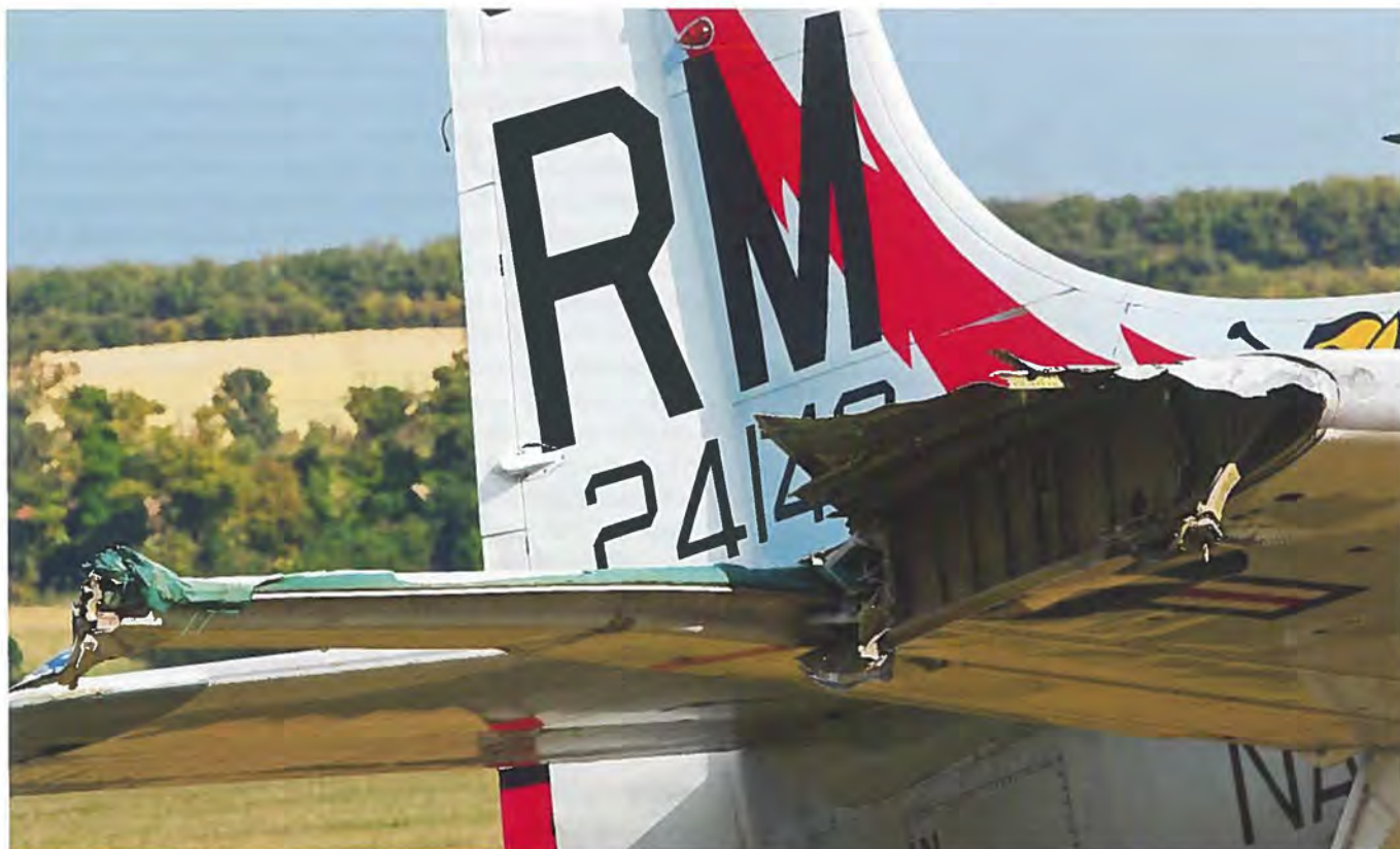
Close-up af den ødelagte vinge. Man ser, at krængeroret blev siddende. Utvivlsomt var det afgørende for, at piloten kunne kompensere for den skæve opdriftsfordeling på de to ikke længere lige store vingehalvdele.
