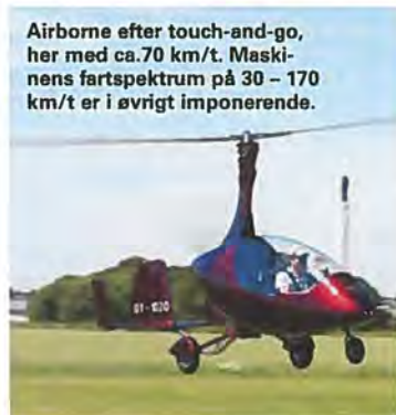
Solo er maskinen airborne på under 100 meter. Derefter flyves der kort i ground effect for at bygge fart op.
