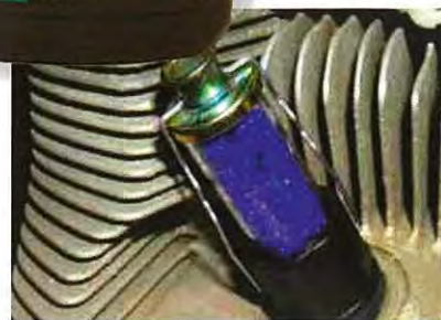
Fugtabsorberende "tændrør" forhindrer korrosion i motoren, hvis den skal overvintres. De ændrer tilmed farve, når de er fugtmættede og skal skiftes.
