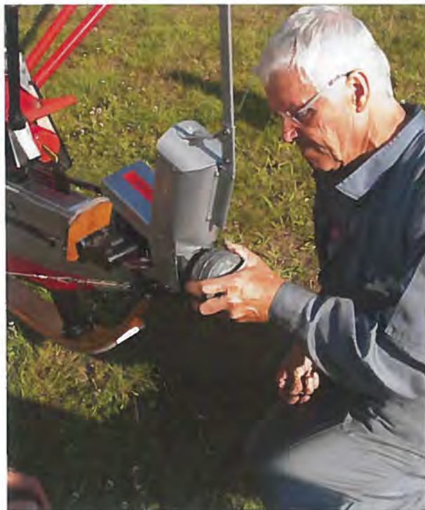
Trimvægtene tilpasses pilotens vægt
