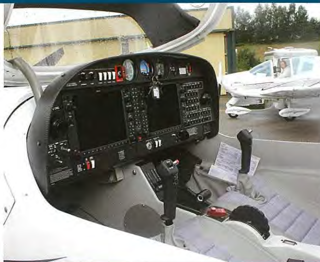
DA 40 NG har et overskueligt cockpitlayout med centralt placeret styrepind.
