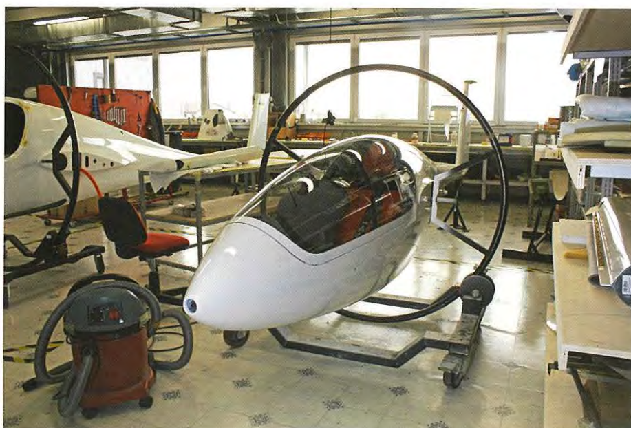
Montering af det ensædede selvstartende UL-svævefly Apis/Bee. Samle-kvaliteten var i øvrigt imponerende. ▼
