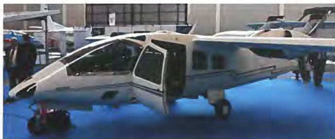
Skycar fik sin debut på udstillingen. Det er et 5 personers fly fra den italienske producent OMA SUD fly til kommercielt brug (taxa og fragtflyvning) konfigureret med to Lycoming IO-360 C1E6- motorer i pusher-konfiguration. En særlig detalje er de dobbelte haleror og den brede bagklap til bagagerummet.
