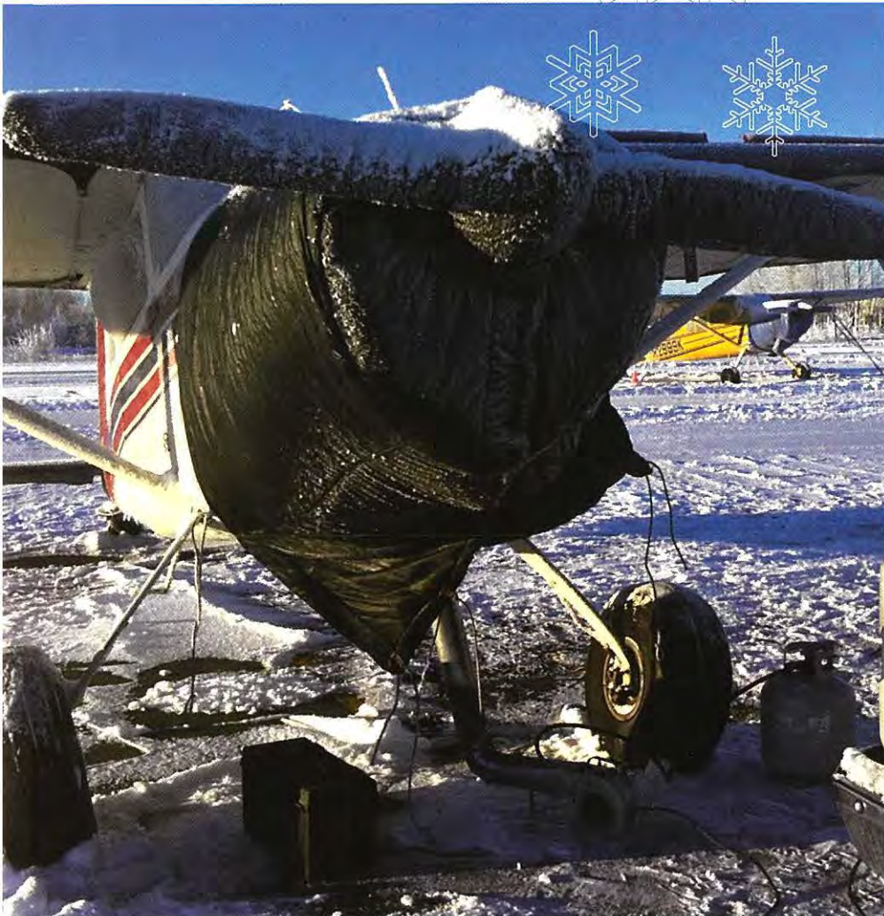
En motorvarmer af blæsertypen skåner motoren. Men husk at olien også skal opvarmes.
