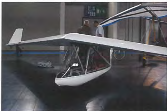
Swift Light E er noget så usædvanligt som en selvstartende, rørstøret hangglider. Den er udstyret med en 10 KW-elmotor og 16 kg Lithium-Polymer-batterier. Swiften kan stige til 1.500 meter eller flyve 45 minutter ligeud. Derefter kan man nyde et relativt godt glidetal på 27, før man igen står på Terra Firma. Ladetiden opgives til at være så lav som 2,5 timer. Swiften kan også udstyres med en benzinmotor på 180 ccm, der udvikler 18 hk. Brændstofforbruget opgives til at være meget lavt – mellem 2 og 2,5 liter i timen, og det giver Swiften en endurance på op til 4 timer. Producenten opgiver ikke værdier for tilladte hastigheder.
