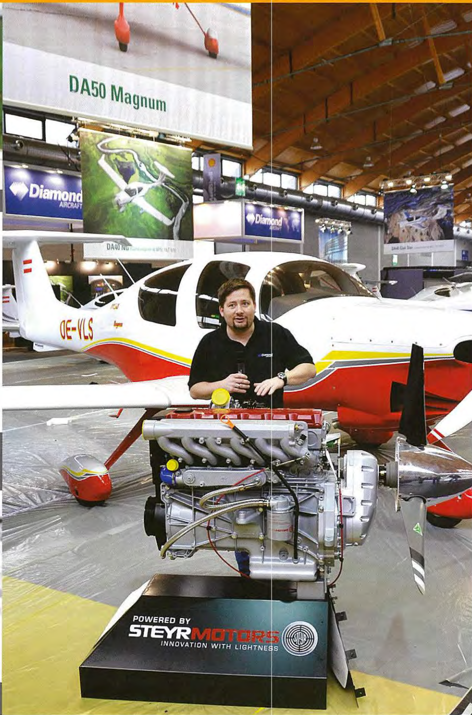
Under årets Aero-messe i Friedrichshafen fremviser Peter Lietz det, som skal blive fabrikkens første motor med mere end 200 hk, AE-500. Den 275 hk-stærke 6-cylindrede motor skal produceres i samarbejde med Steyr og skal første gang i tjeneste i Diamonds flagskib, Magnum.
