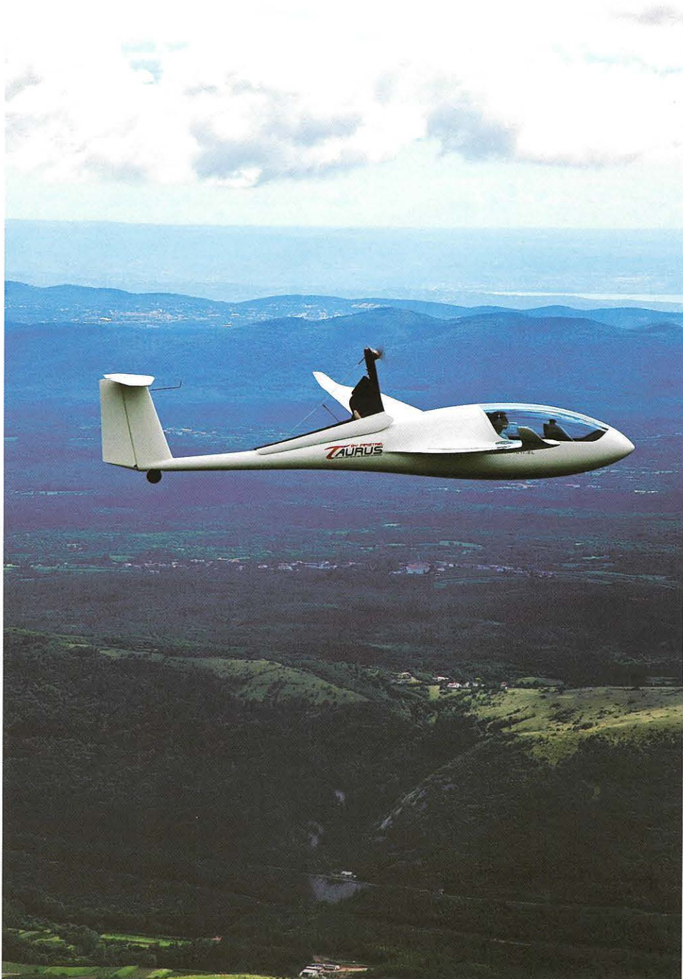
15-meter-vingerne er hentet direkte fra motorsvæveflyet Sinus og giver flyet et glide-tal på 1:41. ▼
