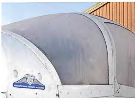
Canopyen isede til under start, og en klud hjalp ingenting, for Søren sad indenfor – og isen udenfor! Her ses det i øvrigt hvor meget udsynet reduceres med dug eller is, for Søren sidder faktisk inde i flyet, men ses ikke på billedet.
