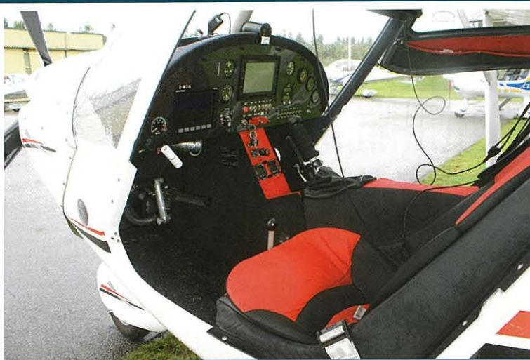
Fin kabine med bedre plads end Cessna 172. Bemærk den aparte (men velfungerende) placering af gashåndtaget, der hvor pinden normalt sidder.
