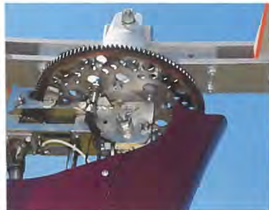
rbillede af rotordesignet i ekstruderet aluminium. I øverste del ses den lodrette aksel til pre-rotatoren. I bunden ses desuden pneumatisk trim og rotorbremse.
