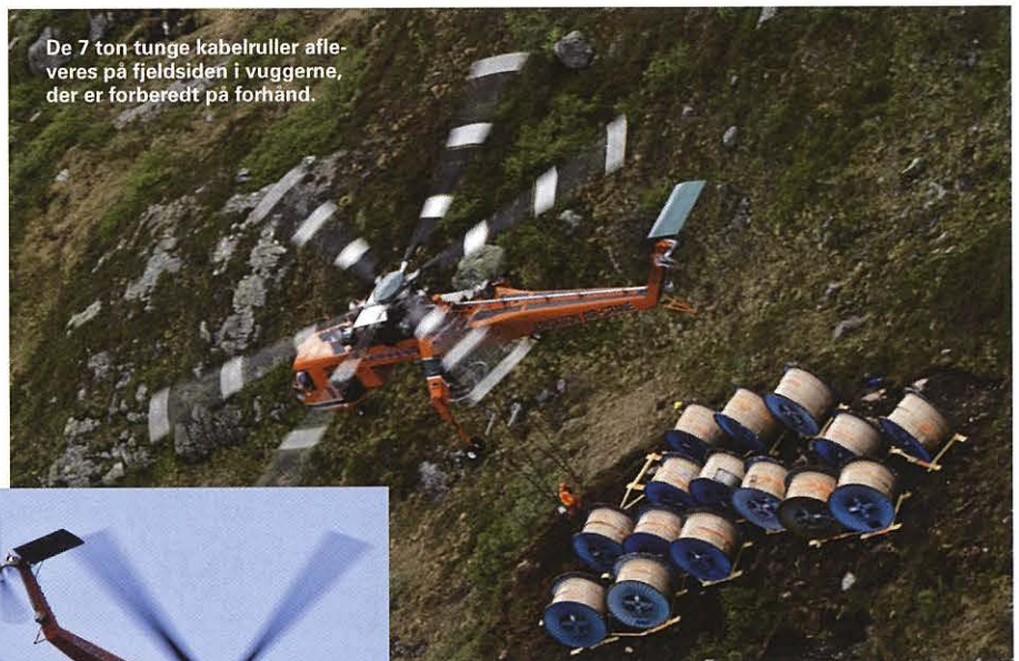
S-64 under en pause. Her ses det specielle "anti-rotation rigging device", der bevirker, at lasten kan placeres meget præcist.
