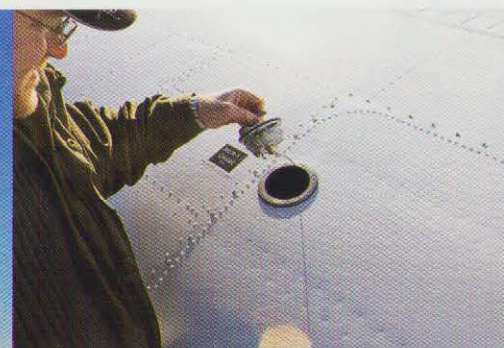
Centurion-motoren er godkendt til at flyve på vej diesel og JetA1. Rækkevidden øges betragteligt med dieselmotor i forhold til benzin – flyet kan flyve næsten 9 timer med nul reserver på tankindholdet (160 l)
