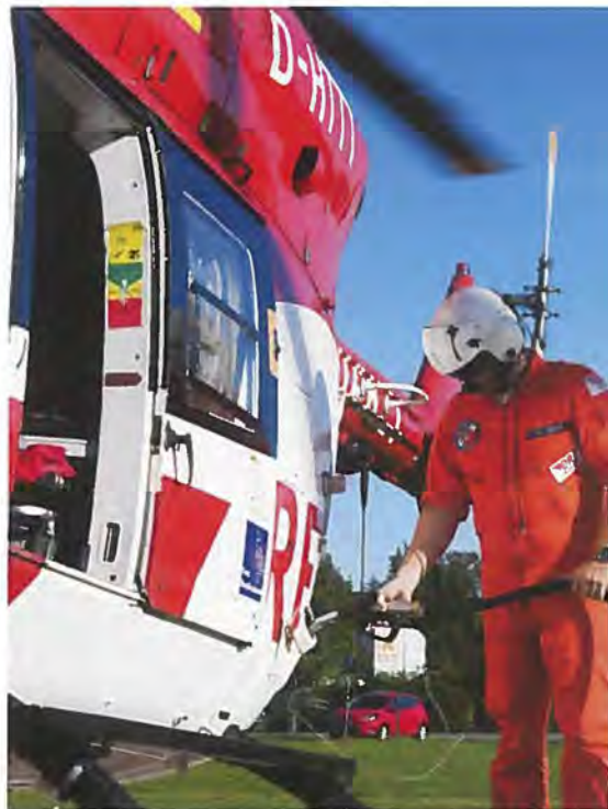
Der refuelles tilbage i Niebüll. Maskinen bruger lige over 200 liter i timen, så tankene skal helst være fyldte, hvis der indløber en mission.
