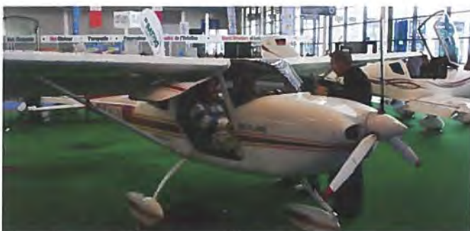
Navnet "Skylane" efterlader vist ingen tvivl om, hvem forbilledet for dette UL-fly er. Tjekkiske Airlony Skylane betegner sig selv som en "mini-Cessna", og det er i lighed med originalen udstyret med "rat" i stedet for den typiske styrepind. Flyet er bygget i glasfiber, men med udstrakt brug af træ i vingekonstruktionen. Det kan udstyres med både Rotax- og Jabiru-motorer. Med en 80 hk Rotax bliver cruisehastigheden 180 km/t.
