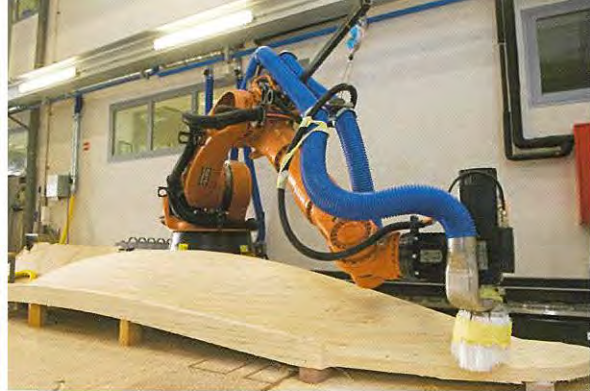
Moderne fabrik: Denne 3D-fræse/støberobot kan lave modeller ud fra digitale tegninger i mange forskellige materialer. ◀
