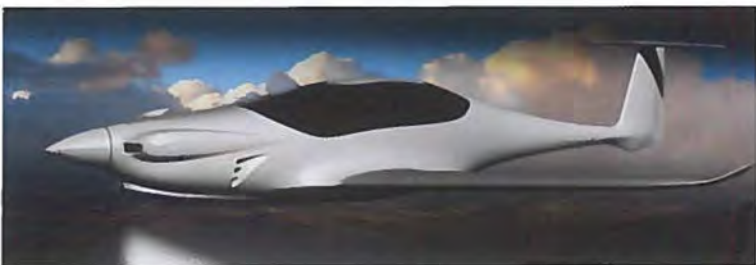
Den 4-sædede Pipistrel Panthera var en af udstillingens mest spændende nyheder. Flyet fra UL-producenten skal certificeres efter CS23/FAR Utility-kategorien og cruiser med over 350 km/t. på bare 210 hk. Brændstofforbruget opgives til 37 liter i timen. Flyet kommer også i hybrid – og ren elversion. Denne plakate er det eneste "bevis" på flyet indtil videre.
