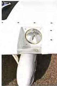
Landingslyset er monteret på vingeforkanten, helt inde ved vingeroden.
