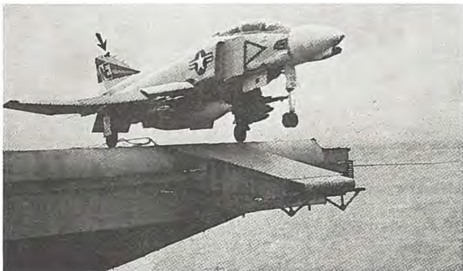
U. S. Navy F-4B PHANTOM jagerbomberfly forlader et hangarskib i Det Sydkinesiske Hav på vej mod Nordvietnam. Pilen viser en antenne i forbindelse med det passive radaradvarselssystem.
