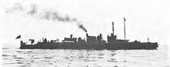
Torpedobaaden T 5 i 1915 (ex HVALROSSEN — TT 10 — 1884). Fik hovedreparation i 1915, hvorved der installeredes to mindre vand-rørskedler i stedet for lokomotivkedel. Den enkelte skorsten erstattedes af to tynde. T 4 (ex DELFINEN — TT 9 — 1883) var tidligere ombygget paa samme maade.
