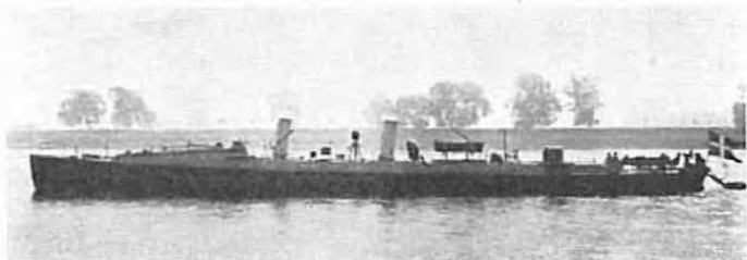
Torpedobaaden HAVHESTEN (TT 17 — 1888) inden afgangen fra Thornycrofts værft. Dæksapparaterne, der stod agter, blev først installeret efter ankomsten til Danmark.
