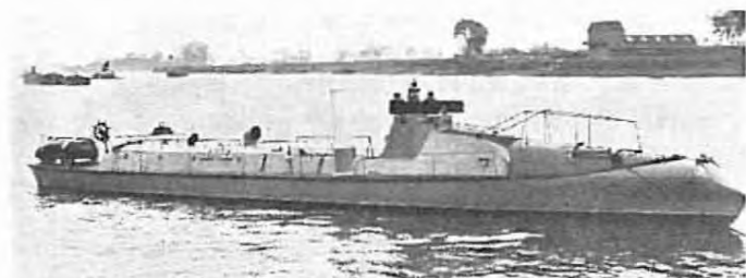
2. classes torpedobaad Nr. 9 (TT 14 — 1886). Skorstenen stod om styrbord — i søsterbaaden Nr. 8 om bagbord af hensyn til baadenes anbringelse om bord (se nederst modstaaende side).
