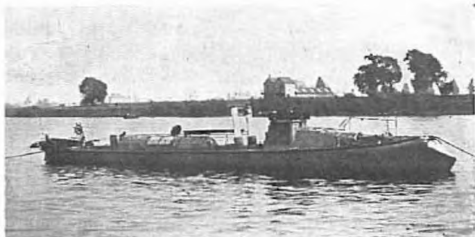
2. classes torpedobaad Nr. 6 (TT 11 — 1884). To sidestillede skorstene. Søsterbaad: Nr. 7. Ogsaa Nr. 4 og 5 havde to sidestillede skorstene.
