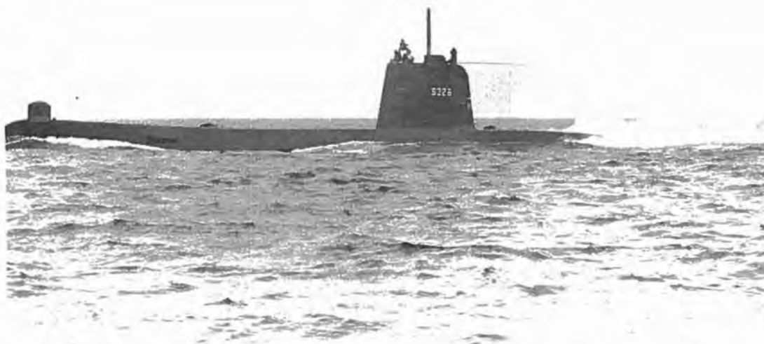
Delfinen . Observationsperiskopet er kørt op. Radioantennen er kørt ned i vandret stilling.
