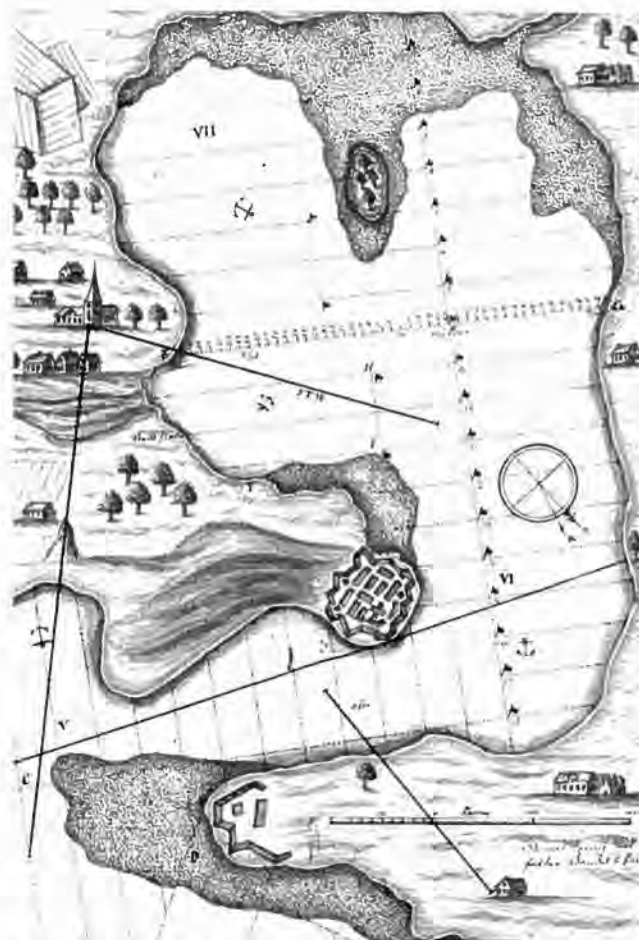
I søkadetuddannelsen lagdes der i perioden i stigende grad vægt på at forberede søkadetterne på kartografisk virksomhed. I afsnittet om „Longimetri“, landmåling, i kadetternes matematikbøger skulle der tegnes forskellige eksempler på opmåling, som dette. Kortet viser ikke noget bestemt sted men er et tænkt eksempel.
