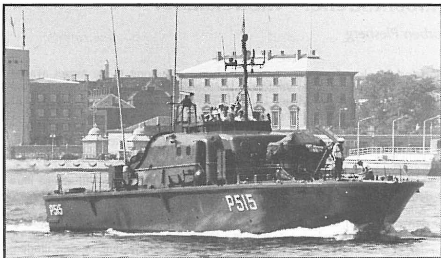
Originalen. P 515 Søulven, MTB af Søløven-klassen, søsat 1966. Længde 30 m, bredde 8 m, dybgående 2,5 m. Deplacement 100 t. Hastighed 50 knob. Besætning 24 mand. Armering: 1 eller 2 stk. 40 mm maskinkanoner, 2 eller 4 stk. 53 cm torpedorør, miner. Foto forfatteren.
