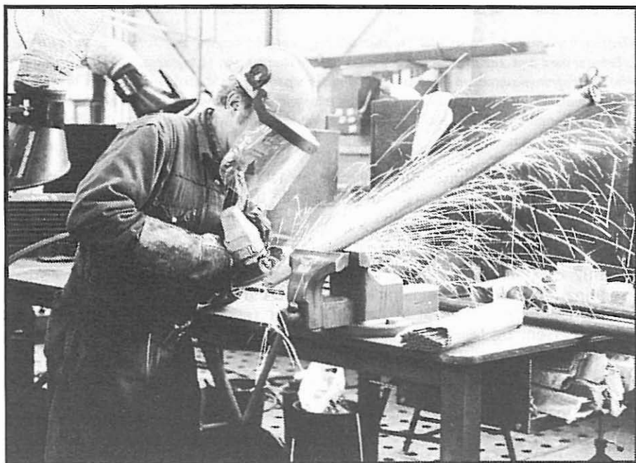
Arbejdssituation fra stålsektionen. En håndværker er på smedeplanet i færd med at bearbejde et arbejdsstykke med en plansliber. Foto forfatteren.
