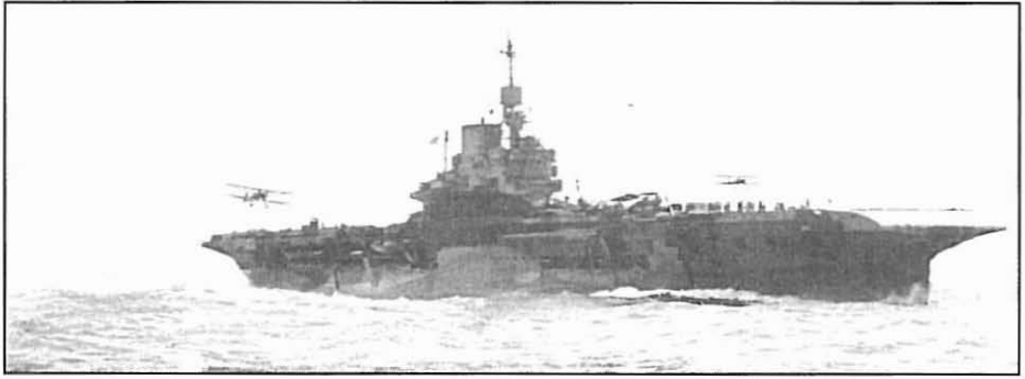
Illustrious var i 1940 et helt nyt skib, det første i en klasse på seks, der som de første hangarskibe var bygget med pansret hangar og flyvedæk. Her ses det med fire Swordfish i landingsrunden.
