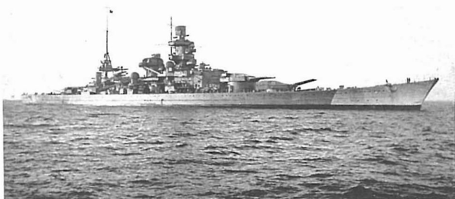
Slagskibet SCHARNHORST. 38.100 ton, 32 knob, hovedbevæbning ni stk. 28 cm kanoner i tre trippletårne.
