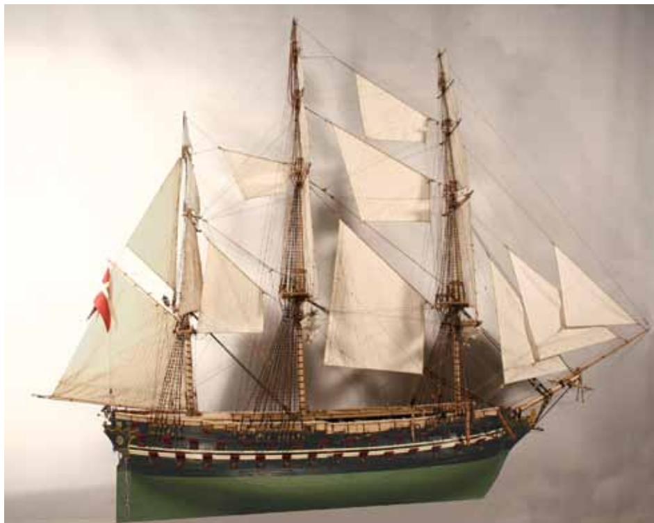
PRINDS CHRISTIAN FREDERIK'S enorme rigning målte 63 meter fra vandlinjen til stortoppens flagknop. Det maximale sejlareal incl. læsejl var på ca. 4300 m 2 .
