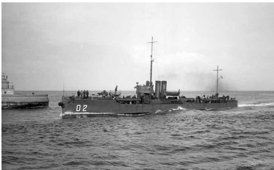
Torpedobåden FLYVEFISKEN af Søridderen-klassen. Båden var en af tre både i denne klasse bygget i perioden 1910-11. Den første, SØRIDDEREN, blev konstrueret og bygget på det anerkendte engelske værft Yarrow & Co i Glasgow. De to følgende både FLYVEFISKEN og SØULVEN blev bygget på Orlogsværftet. Deplacement: 225 ton, fart: 27,5 knob, bevæbning: fire stk 45 cm torpedoer og to 75 mm kanoner.
