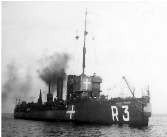
Den tidligere torpedobåd NORDKAPEREN, fotograferet som patruljebåd en gang i perioden 1939-43. Båden var én af SPRINGEREN-klassemens ti både på 110 tons, som blev søsat i perioden 1916-1919. (FBIB)
