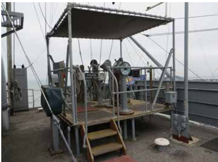
Herfra manøvreredes skibet under sejlads, da der er meget dårligt udsyn fra styrehuset. Det er pakket ind i beton og kun har tre ganske små vinduer. (Tom Wismann)
