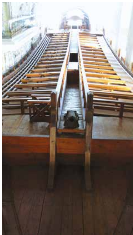
Fotografi af dæk med rotofterne på en rekonstruktion af en lille galej. Søfartsmuseet i Genua. (Ole Mortensøn)
