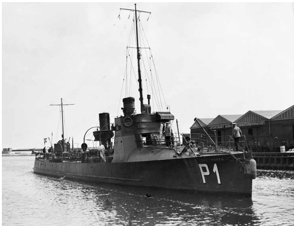
Torpedobåden HVALROSSEN en af en klasse på tre både. De to andre hed DELFINEN og SVÆRDFISKEN og alle tre blev bygget på orlogsværftet i 1912-13. Bådene var under 1. Verdenskrig nogle af Søværnets bedste. De havde et displacement på 182 ton, en længde på 45 m, bredde 5,2 m og en dybgang på 2,2 m. Bevæbningen bestod af en 75 mm kanon og fire stk. 45 cm torpedoer. (Forsvarsgalleriet)
