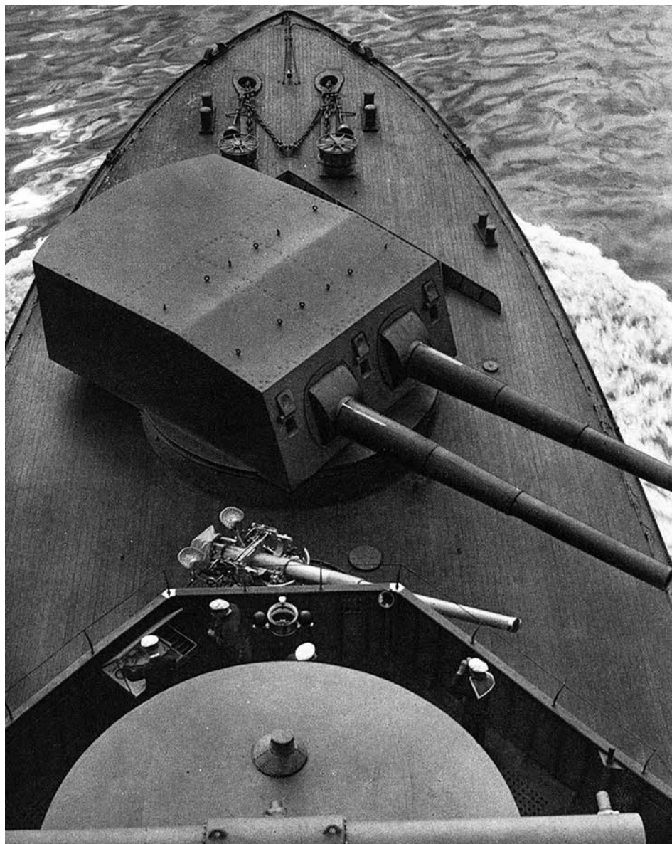
VÄINÄMÖINEN med det forreste 254 mm kanontårn. Det interessante ved billedet er, at der er monteret en enkelt eks-russisk Obuhov 102 mm kanon der, hvor den forreste dobbelte Bofors 105 mm senere blev monteret.
