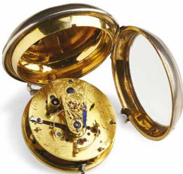
Fig. 12. John Arnold & Son lommekronometer nr. 438/739. Bemærk Z-balancen.
