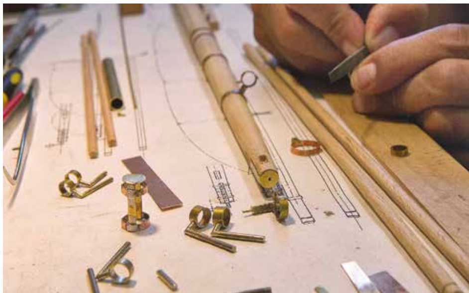
Fremstilling af nogle af ræerne og stængerne til ST. GEORGE, der monteres med forskellige former for forstærkningsringe og beslag i slagloddet messing. (Steffen Ortmann, OMBL)
