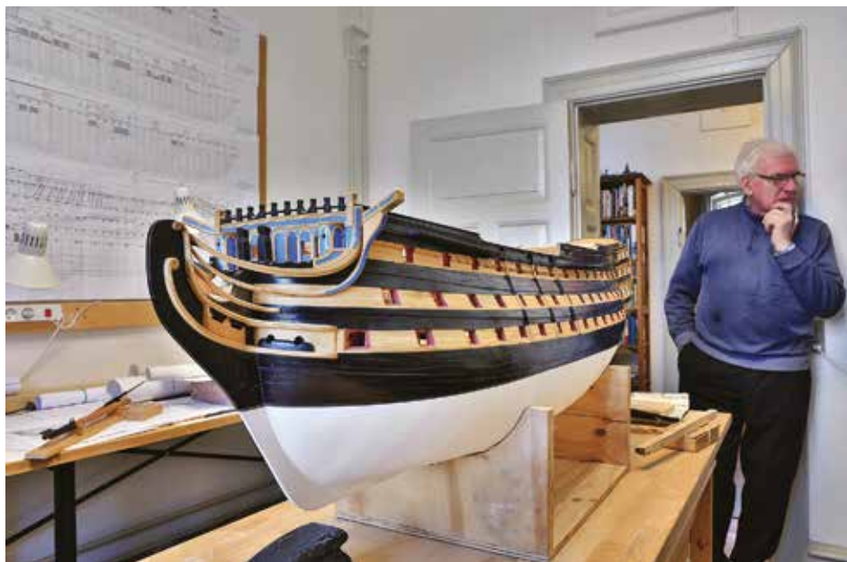
Modellen af ST. GEORGE, som den tog sig ud marts 2019. Den hvide bundfarve er en grundmaling, der har til formål at sikre en effektiv hæftning af de omtalte bånd af kobberfolie, der skal dække hele bunden op til underkanten af den sortmalede skibsside. (Steffen Ortmann, OMBL)
