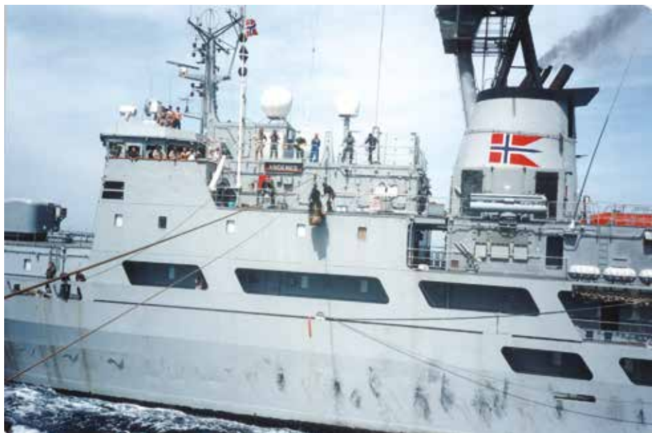
Her bliver der foretaget RAS (Replenishment At Sea) ved brug af metoden "Light Jackstay" mellem OLFI og ANDENES. Bemærk ASW (antiubåds) torpedoerne i triple udskydningsrør på dækket nedenfor skorstenen. (Marinens Bibliotek)
