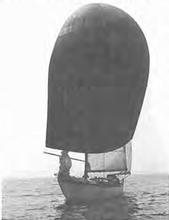
THYRA med spileren sat
