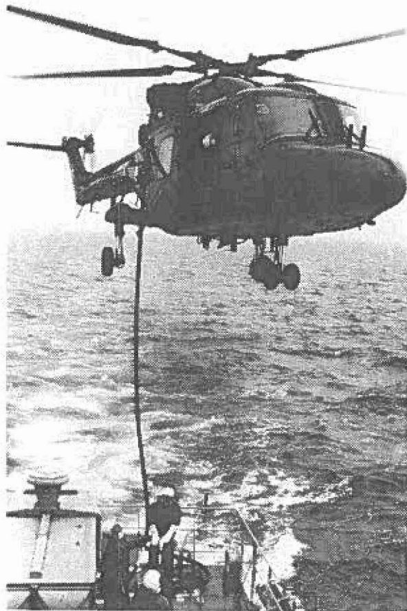
Efter tilgangen af LYNX-helikoptere er brændstofforsyning af helikoptere i luften fra skibe under gang blevet muliggjort og indgår nu i den daglige rutine. (SVN FOT)
