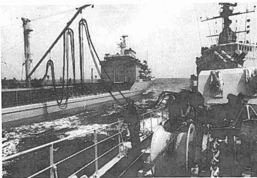
PEDER SKRAM modtager - under gang - olie fra det canadiske tankskib PROTECTEUR.
