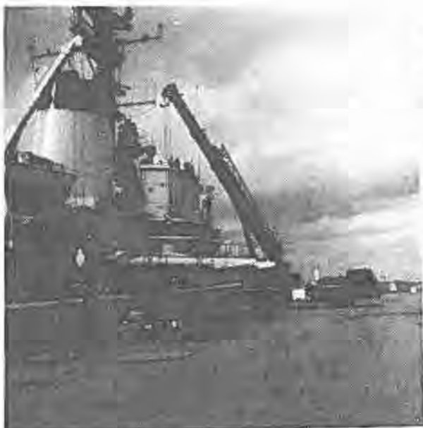
Her ses kranen under udtagnin- gen af torpedorørene i PEDER SKRAM (SVN FOT)
