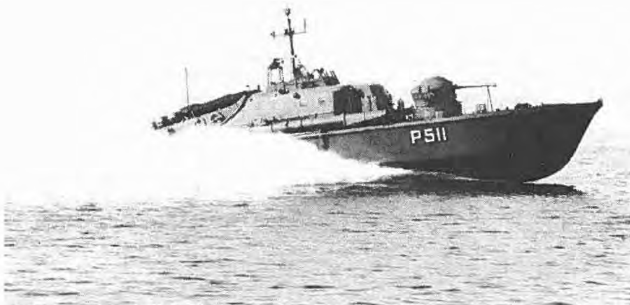
Torpedobåden SØRIDDEREN - her armeret med 1 stk. 40 mm kanon og 4 torpedorør (SVN FOT)
