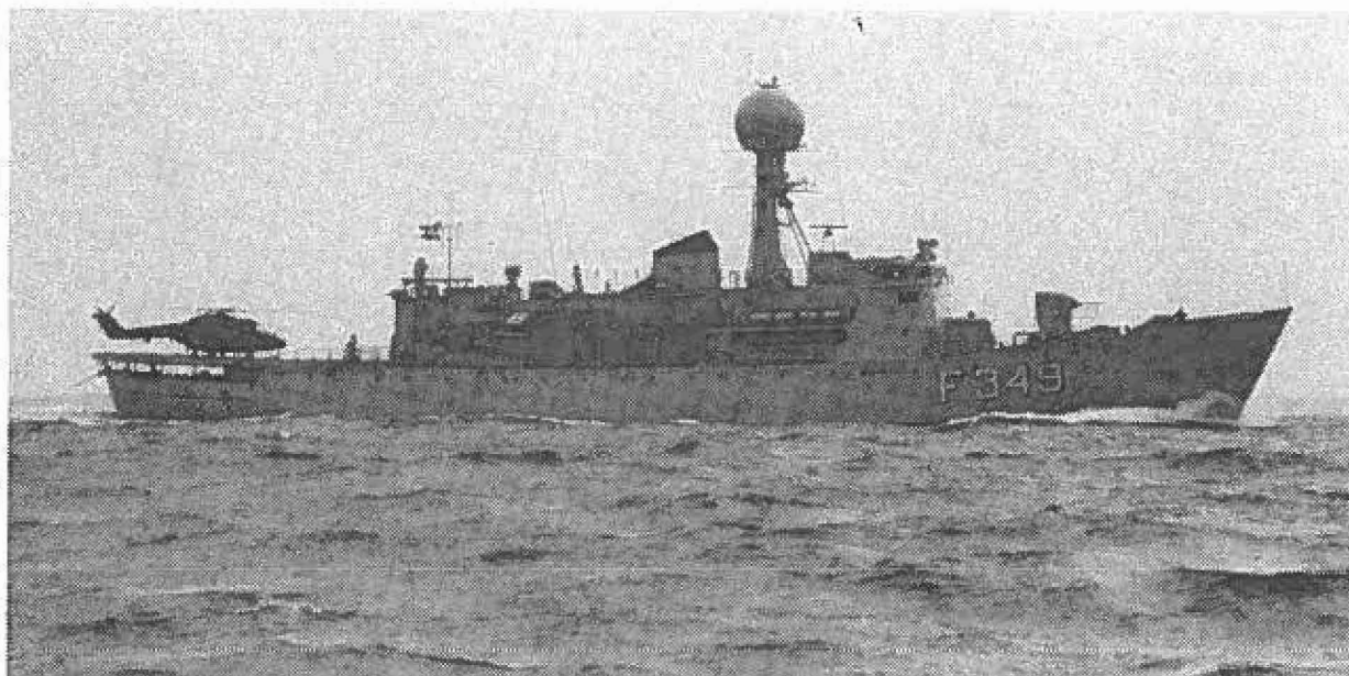
Inspektionsskibet VÆDDEREN under gang - bemærk den nye radardome, der efterhånden indføres i samtlige inspektionsskibe. (SVN FOT).
