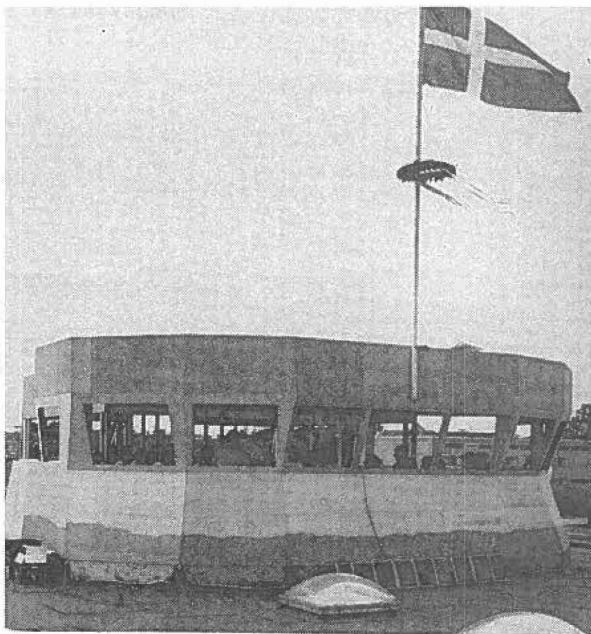
Glimt fra rejsegildet - træbygningen er en model i fuld skala af operationsrum og kommandobro i STANDARD FLEX-300.
