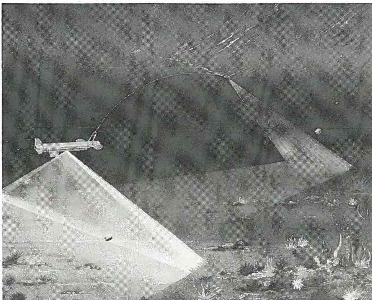
Side-scan sonarsystem til STANDARD FLEX 300 minerydningsrolle afsøger havbunden trukket af overfladedrone. (Thomson Sintra Illustration FOT).
