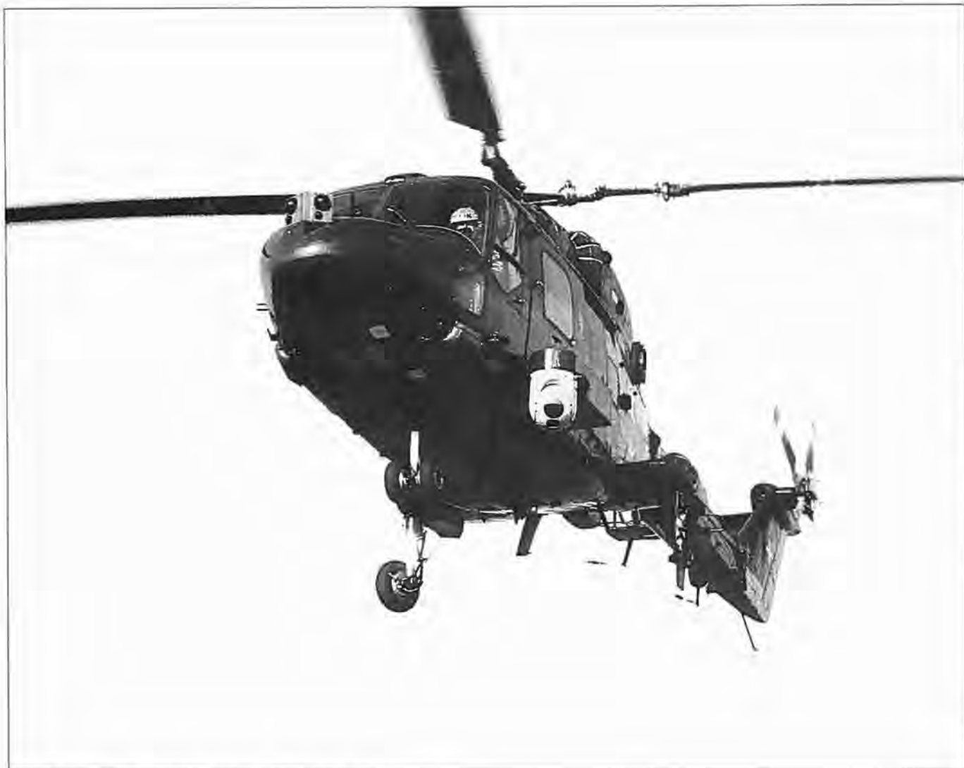
Taktisk LYNX udstyret med ESM og FLIR i rollen som flådehelikopter under øvelse med søværnets kampenheder
