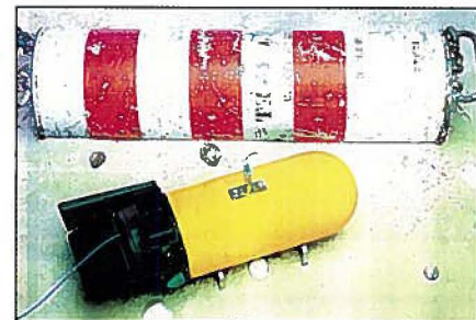
DAMDIC er »kastet« og er nu klar til bortsprængning af minen. Bemærk trådspolekablet fra DAMDIC (til moderskibet)
