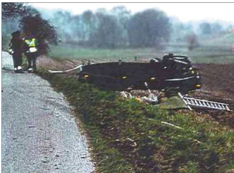
Dette illustrerer et desværre ikke usædvanligt ene-uheld. Køreren blev overasket af et vejsving og så gik det galt: Den militære lastbil fik et hjul ud i rabatten, køreren forsøgte at styre kontra og... – billedet taler for sig selv
