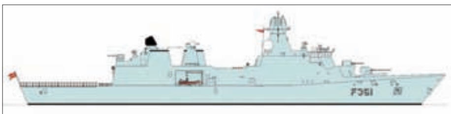
Patruljeskibet udrustet med 35 mm kanon, SMART L (varslingsradar), APAR (ildledelsesradar), 76mm kanon og 127mm kanon.
