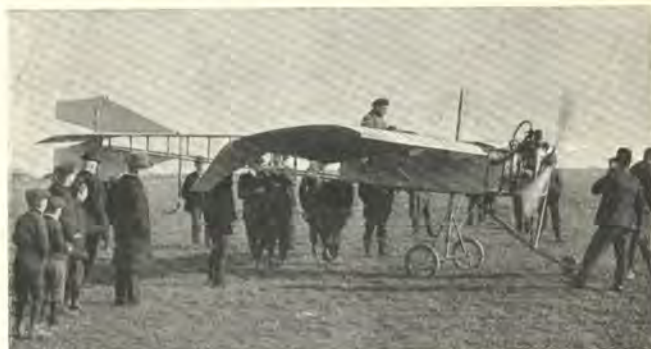
Fig. 17. Berg og Storms Monoplan. (Bivingerne er nu fjærnede og erstattet af „Gauchissement“).
