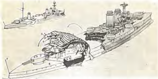
Fig. 2. Virkningen af Eksplosionen paa «Libertés» Agtorende. (Forskibet blev fuldstændig splintret. De 2 agterste 30,5 cm Kanoner er næsten ubeskadigede).
