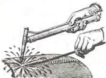
(Fig. 3). Autogensvejsning. Man ser Brænder og Fyldemateriale.
