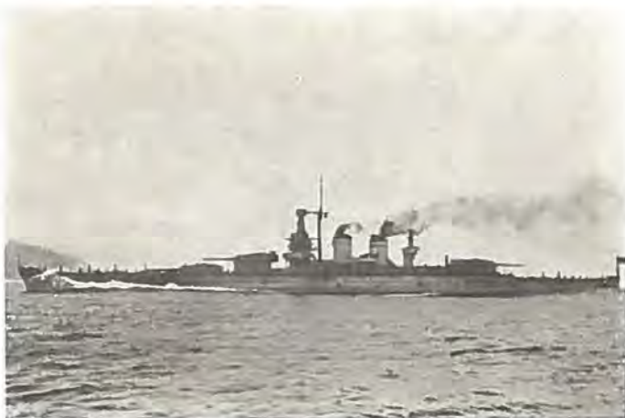
Det nye italienske Slagskib VITTORIO VENETO paa Prøvefart (Agterste Taarns Højde skyldes Hensyn til Katapulten paa Agterdækket)
