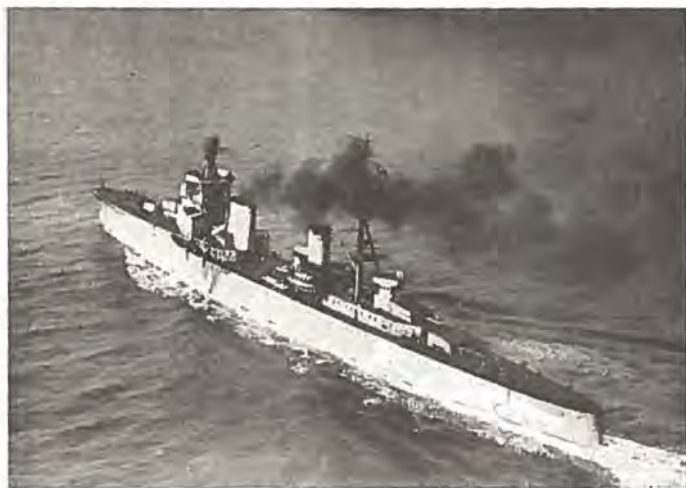
Den italienske lette Krydser A. DI GIUSSANO af »Condottieri-Klasserne« (Bemærk Ildlederstationens Anbringelse paa Fire-Bens-Masten og Brokonstruktionen omkring denne)
