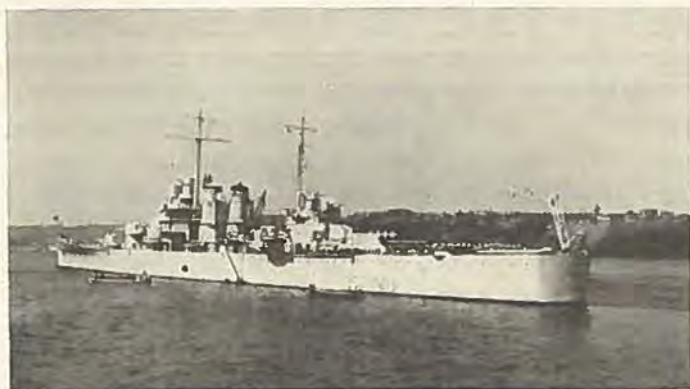
U. S. S. WICHITA — den nyeste amerikanske, svære Krydsler (Bemærk »Flush-Deck« og Agterskibets Højde og Form).
