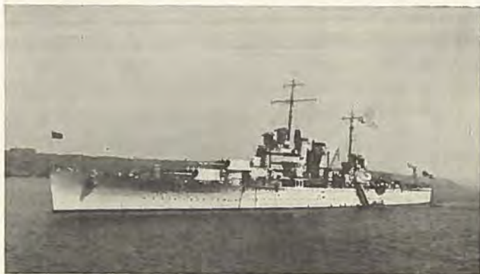
U.S.S. WICHITA (Bemærk 12.7 cm A.L.K. i lukkede Panserskjolde over Hovedarmeringen og udfor Broen)
