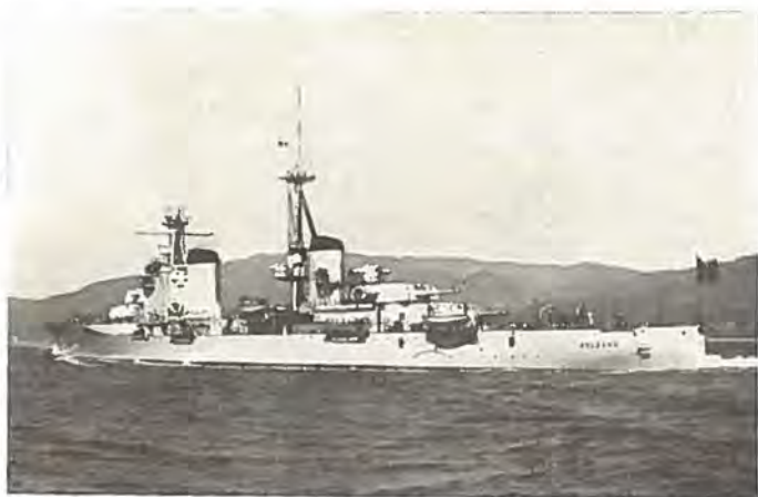
BOLZANO — den nyeste italienske, svære Krydsler (Bemærk Brokonstruktionens Sammenbygning med forreste Skorsten og den ringe Afstand mellem de to Kanoner i Dobbelttaarnene)
