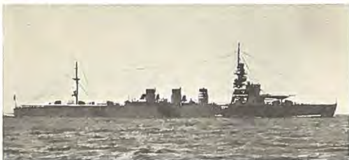
Japanisk let Krydser YURA med Hangar paa Broen og fast Startplatform over Fordækket
