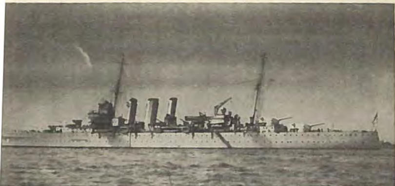
Engelsk svær Krydser DEVONSHIRE med drejelig Katapult agten for Skorstenene. CUMBERLAND-Klassen har ved Ombygning 1936-38 faaet en stor kasseformet Hangar foran for Stormasten og fast tværskibs Katapult foran for Hangaren.
