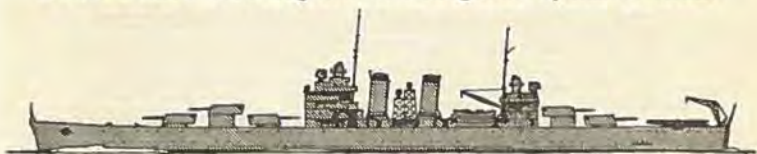
Amerikansk 10.000 Tons let Krydser PHILADELPHIA. Flush Deck, 2 drejelige Katapulter paa Agterdækket. Agterskibet indrettet til Hangar.
