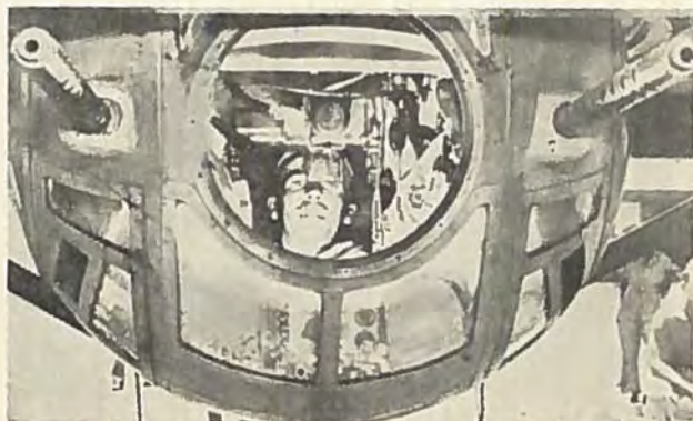
Fig. 8. 2 Stk. MG i Taarn under Krop. (12.7 Colt i Boeing Fortress).
