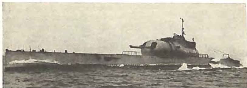
Fransk Ukrydser SURCOUF, armeret med 2 Stk. 20,3 cm Kanoner. I Agterkant af Overbygningen findes vandtæt Hangar for et mindre Søluffartøj.
