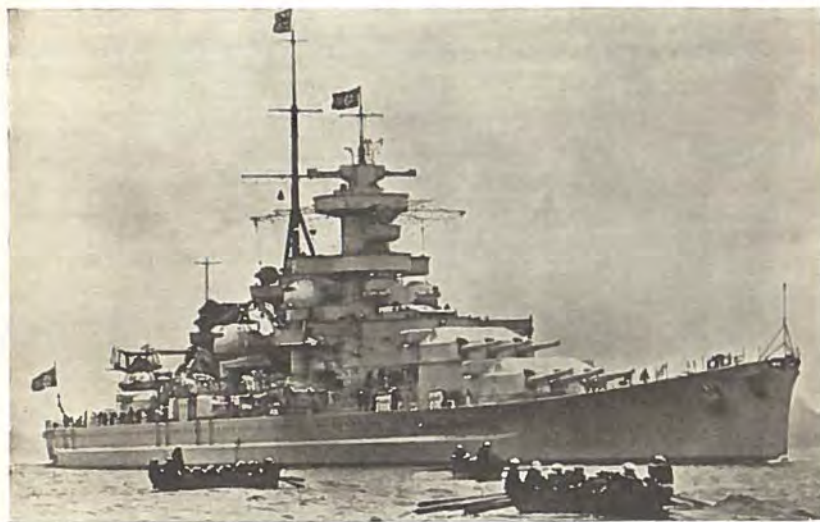
Tysk Slagskib GNEISENAU med 2 Katapulter — paa Taget af agterste Tripletaarn og paa en særlig Katapultopbygning lidt agten for Skorstenen. Luftfartøjerne ses staaende paa Katapulterne med sammenklappede Vinger.
