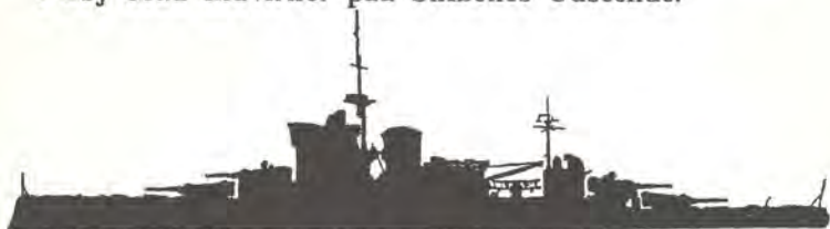
Engelsk Slagskib WANSPIRE efter Ombygning 1937. Agten for Skorstenen findes Hangar til 4 Luftfartøjer. Fast tværskibs Katapult foran for Stormasten.
