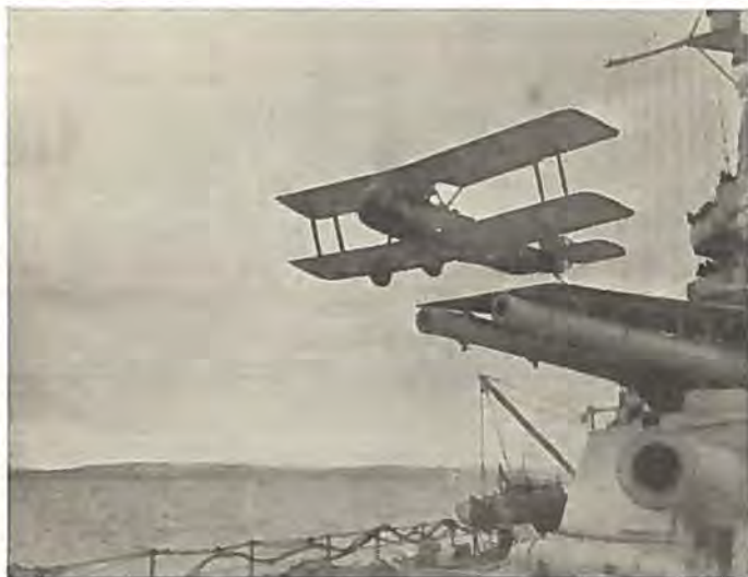
Engelsk Sopwith »Camel« Jagtplan med Hjulstel starter fra Slagskibet WANSPIRE. Startplatformen paa Kanontaget er forlænget ud over Kanonerne. Denne »Forlængelsesplatform« kunde hurtigt fjernes, hvis Kanonerne skulde anvendes. Kanontaarnet drejedes op mod den op- parente Vind. Skønt de engelske Slagskibe i de nærmeste Aar efter forrige Verdenskrig kun sjældent udrustedes med Luftfartøjer, beholdt man dog Startinstallationen om Bord til 1925. Forlængelsesplatformene var dog stuvet af Vejen. (Foto 1918)
