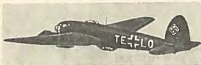
Fig. 14. 2-mot. Bomber: Heinkel 111 K. 1 Stk. 20 mm M.K. 6 - 7.9 - M.G.
