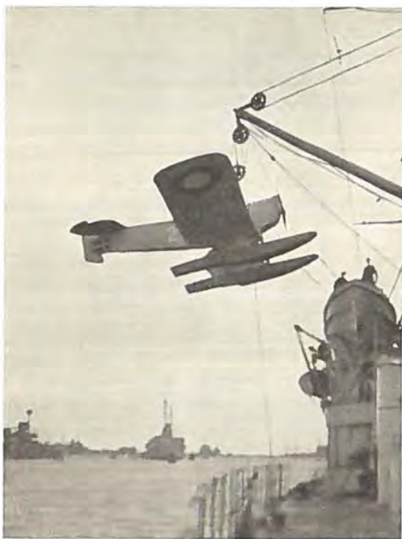
Et »Brandenburg«-Sølufftartøj sættes om Bord i Kystpanserskibet PEDER SKRAM 1922. Luftfartøjet placeredes tæt agten for Skorstenen
