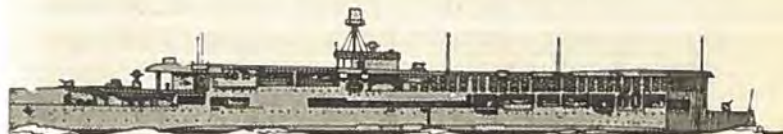
Engelsk Aërodromskib Furious efter Ombygning 1939. Luftsøtset er placeret paa Bakkdækket og Agterdækket samt i lave »Svalereder« paa Skibssiden. Skønt Manøvreringen nu altid foregaaer fra Broen paa Øen, blev Navigationstaarnet, som ses forude paa Flyvedækket, bibeholdt ved Ombygningen
