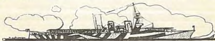
Engelsk Hangarkrydser VINDICTIVE (1918) med Startdæk for Landluftfartøjer foran for Broen og Landingsdæk agten for Skorstenene.
