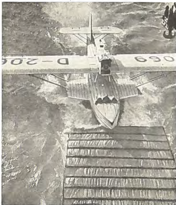
Indbjergning af Luftfartøj ved Hjælp af Hein's Landingssejl agter. Luftfartøjet er »landet« paa Dødvandet agten for Landingssejlet og ses i Færd med at løbe op paa Sejlet. Foroven tilhøjre ses Hejsblokken.
