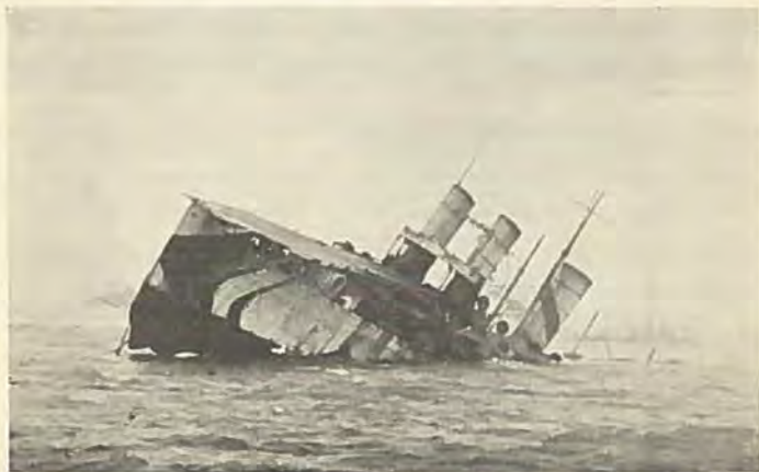
Hangarskibet CAMPANIA (»Mixed Carrier«) synker paa Firth of Forth 5/11 1918 efter Kollision med Krydseren GLORIOUS. Man bemærker Startdækket, der fra Broen falder temmelig stejlt ned mod Stævnen. Skorstenene var placeret i en Trekant — den agterste i Diametralplanet — de to forreste i Borde tværs for hinanden med Plads til Passage for startende Luftfartøjer.
