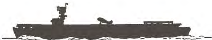
Silhuett af amerikansk Escort-Aërodromskib SANGAMON (Silhuetten er tegnet efter et ikke helt skarpt Fotografi, hvor der agter findes en mindre Ophugning, som muligvis kan være en i Borde staaende Katapult)
