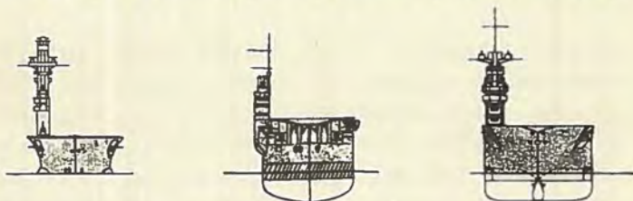
Aërodromskibene HERMES, BÉARN og SARATOGA set forind. Man bemærker Ø-Konstruktionens Placering i BÉARN som en Slags »Karnap« uden paa Skibssiden
