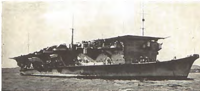
Verdens mindste Aërodromskib, den kun 7.100 Tons japanske Ryuzyo (den opstigende Drage). Glatdækstype. Man bemærker de vandrette Skorstene paa Siden af Hangaren. Under Start og Landing klappes Masterne vandret ned.
