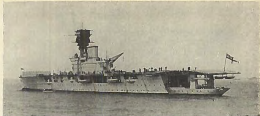
Engelsk Aërodromskib HERMES. Man bemærker Skibssidens udfaldende Form, Flyvedækkets Bøjning agter og Krænen i Agterkant af Øen. Hovedartmeringen (Fladbaneskyts) står i Skjolde i Aabninger i Skibssiden. Forude er rejst en Vindskærm for at give Læ paa Flyvedækket
