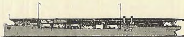
Amerikansk Glatdæks-Aërodromskib LANGLEY (ombygget Kuldampfer) med to Klapskorstene om Bagbord. I 1937 fjernedes den forreste Trediedel af Flyvedækket
