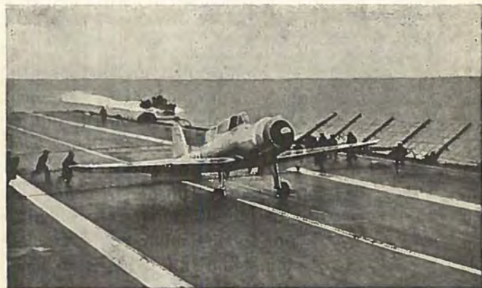
En Blackburn »Skua« (Fighter-Bomber) lander paa Flyvedækket og Folkene løber til for at frigøre Maskinen af Bremsewirene og føre den af Vejen. Paa Planernes Agterkant (tæt ved Kroppen) ses Landingsklapperne neddrejet
