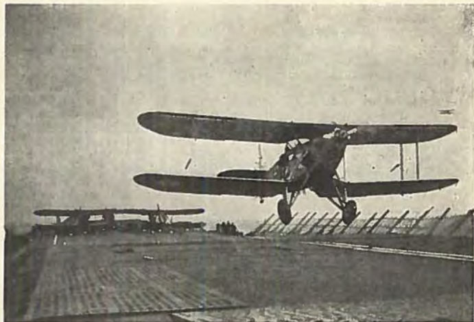
Et Blackburn Torpedoplan starter fra Flyvedækket af Furious. I Børde Sikkerhedsnettet. Vindskærmene, der ligner Ristværker, er lagt ned
