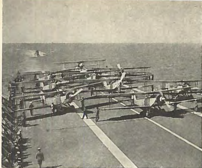
Luftfartøjer under Klargøring paa Flyvedækket. Opstanderne til Bremsewirene er lagt ned af Hensyn til Luftfartøjernes Rangement
