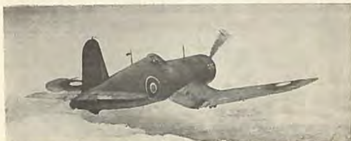
Fig. 1. Corsair. Ensædet Jager-Bomber. Hangarskibsbaseret. Amerikansk Type. Armering 6 Stk. 13 mm, 1 500 kg Bombe.
