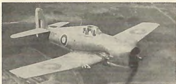
Fig. 3. Hellcat. Ensædet Jager-Bomber. Hangarskibsbaseret. Amerikansk Type. Armering 6 Stk. 13 mm, 1 Stk. 250 kg Bombe.
