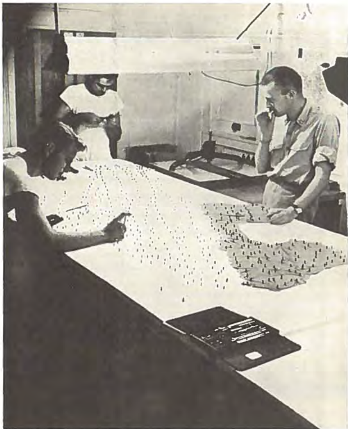
Om Bord paa U.S.'s Opmaalingsskib Bowditch sammenlægges gennemhullede Skabeloner af Luftfotografier, saaledes at de passer til disse Kontrolpunkter.
