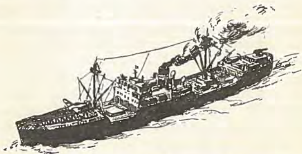
Armeret Koffardiskib med fast, langskibs Katapult paa Bakken. Under Konvojseljads var en stærklar »Hurricane«-Jager (med Hjulstel) placeret paa Katapulten.
