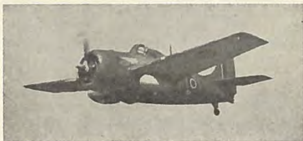
Fig. 4. Wildcat. Ensædet Jager-Bomber. Hangarskibsbaseret. Amerikansk Type Armering 6 Stk. 13 mm, 1 Stk. 125 kg Bombe. Bemærk Ekstra-Benzinfankene under Planerne.
