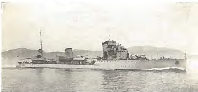
Italiensk Jager af Navigatori -Klassen. Man bemærker Opstillingen 2 + [2] + 2 med samme Ildhøjde for alle Kanonerne.
