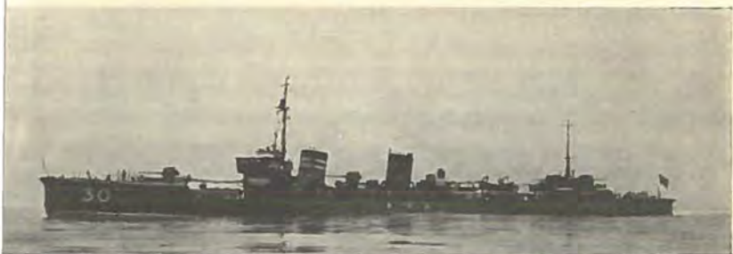
Japansk Jager »Nadakaze« (Storm over oprørt Hav) (1920). Opstilling: 1 + [1] + [1] + 1 , alle Kanoner i samme Højde.
