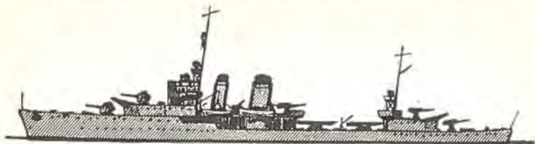
Amerikansk Jager »Aylwin« (1934). Man bemærker dels Opstillingen. (2 \times 1) + [1] + (2 \times 1) , og dels at de to forreste, mere »udsatte« Kanoner er dækket af Skjolde, medens de tre andre Kanoner staar helt ubeskyttet.
