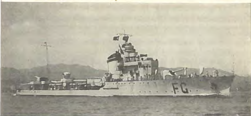
Italiensk Jager »Folgore« (1931). 2 + 2. Kanonerne i Skjoldene er koblet sammen og staar meget tæt ved hinanden.
