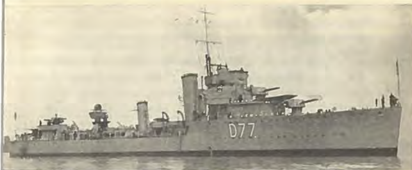
Engelsk Jager »Whitshed« (1919). Man bemærker Halvskjoldene og de ulige høje og ulige tykke Skorstene.
