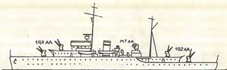
Engelsk Sloop ( Escort Vessel ) 1938. Armering: 8 Stk. 10.2 cm Luftskyts, (2×2 + (2×2). De nyere engelske Sloops har nu Gittermast ligesom Jagerne, og da Skorstenen ofte staar tæt ved Gittermasten, er der Mulighed for Forveksling med Jageren. Ved Fjernkending erindres, at Jagerne har kort Bak, Sloops har langt Bakkdæk til godt agten for Skorstenen og ingen Jagerø eller Jagerpukkel.
