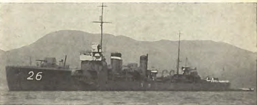
Japansk Jager »Mutuki« (Januar) (1925). Man bemærker Torpedo- apparaterne foran for Broen.
