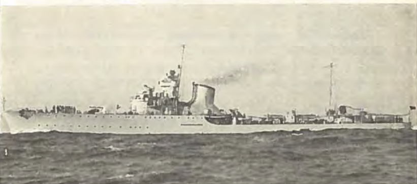
Italiensk Jager »Sirocco« (1934). 2 + 2. Dobbeltskjoldet agter staar i samme Højde som forreste.
