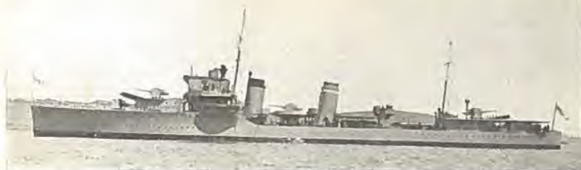
Engelsk Jager »Exmouth« (1934), Flotilleleder for E-Jagerne. Man bemærker den 5te Kanon mellem Skorstenene. Flotillelederne havde tidligere sort Skorstenstop som Kendetegn.
