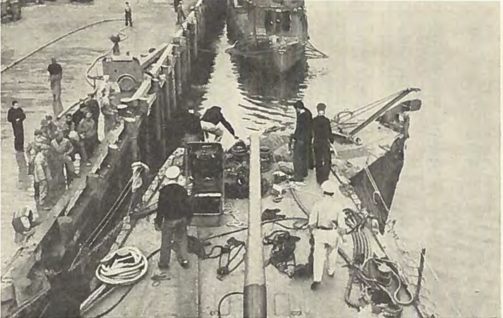
Fig. 1. Kollisionsskade. Denne destroyer blev bragt i havn - takket været en effektiv havaritjeneste, der formåede at begrænse læskaden, til trods for, at kollisionsskoddet ikke var intakt. - Det mest strålende eksempel på redning af en destroyer trods svære havarier er vel den amerikanske jager »Kearny«, der under neutralitetspatrulje i Nordatlanten den 16. oktober 1941 kom en gruppe brændende tankskibe fra en konvoj til hjælp og herunder fik en torpedotræffer fra en ubåd. Torpedoen detonerede ved anslaget og ramte ca. 1½ m under vandlinjen agten for broen lige ved forreste fyrpladsrum. Dette rum vandfyldtes, 11 mand blev dræbt, al forbindelse med maskinrummet m. v. blev ødelagt, damp og styregrejer svigtede, og jageren lå hjælpeløs et stykke tid, før det lykkedes at få skaderne under kontrol, hvorefter den fortsatte til Island. »Kearny« blev repareret og var i tjeneste igen i begyndelsen af april 42.
