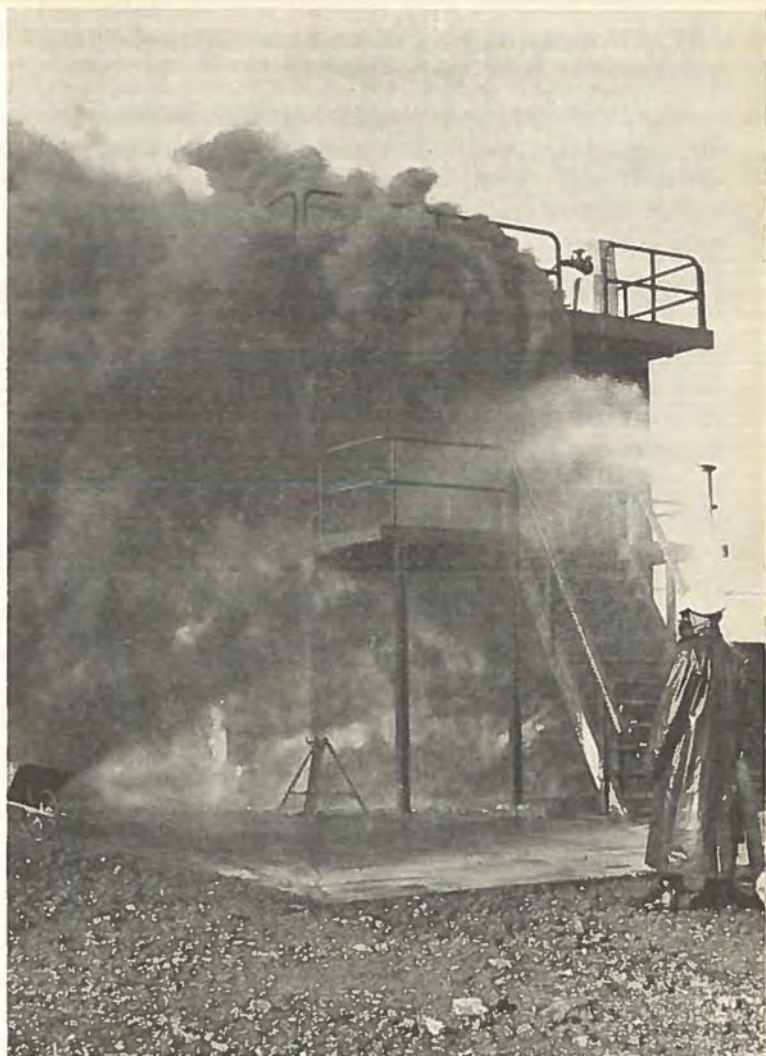
Fig. 4. En skrogbrandbygning fra en Fire-Fighting School i England. En oliebrand er »startet op«. Et af brandslukningsholdene skal trænge ind i bygningen gennem den vandtætte dør på dæk I.
