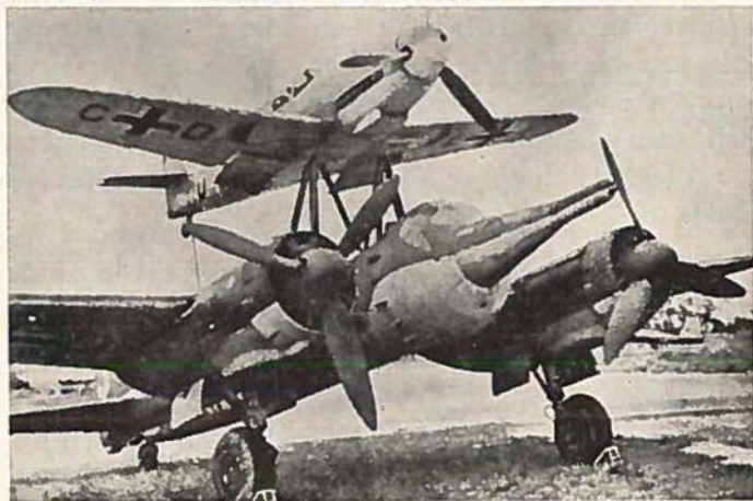
Oversat fra engelsk: „Ombygget JU88-A-4'er transporterede en 7726 lbs. hulkadning som krigshoved og den nederste komponent i Gerät BEETHOVEN/MISTEL 2-våbnet. Maskinen som er vist her førtes til målet af BF 109F Jagerflyet monteret over midterdelen“
