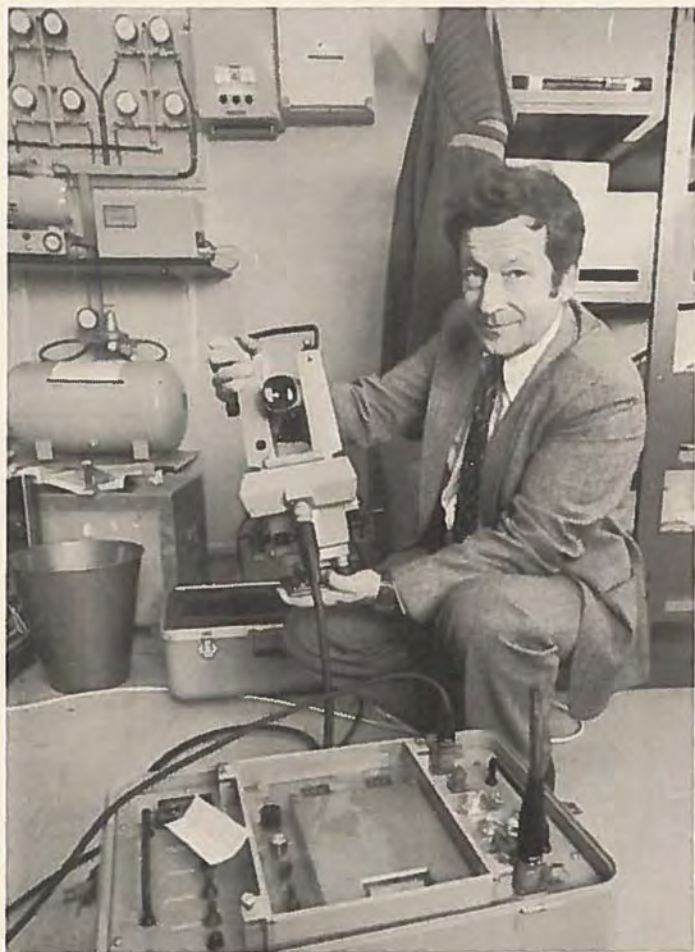
Chefen for NATO FORACS NORWAY, KK T. Berg fremviser en teodolit med automatisk dataudlæsning.
