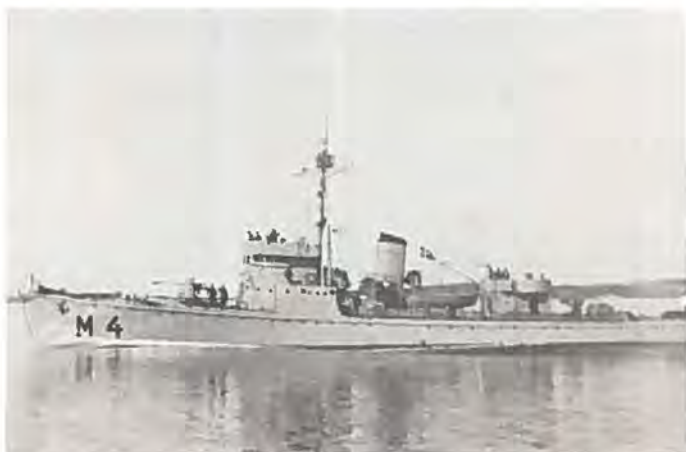
Ministrygeren SØRIDDEREN bygget på Orlogsværftet 1942. Depl. 247 ts, l. 51,5 m, b. 6,3 m, d. 1,9 m. Besætning: 48. Maskine: gearet turbine 2200 HK/19 knob. Armering: 2-76,2 mm P.K., 4-20 mm AL, 2 dybbdebombekastere.
