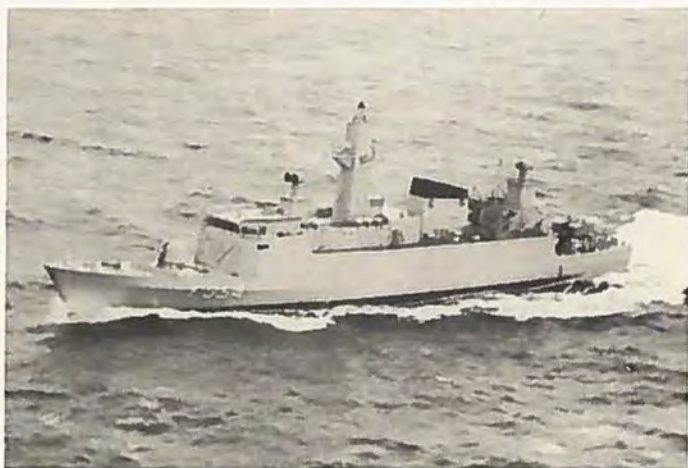
Korvetten NIELS JUEL fotograferet under den første prøvesejlads 27 november 1978. Luft- og overfladevarslingsantenner ej monteret.
