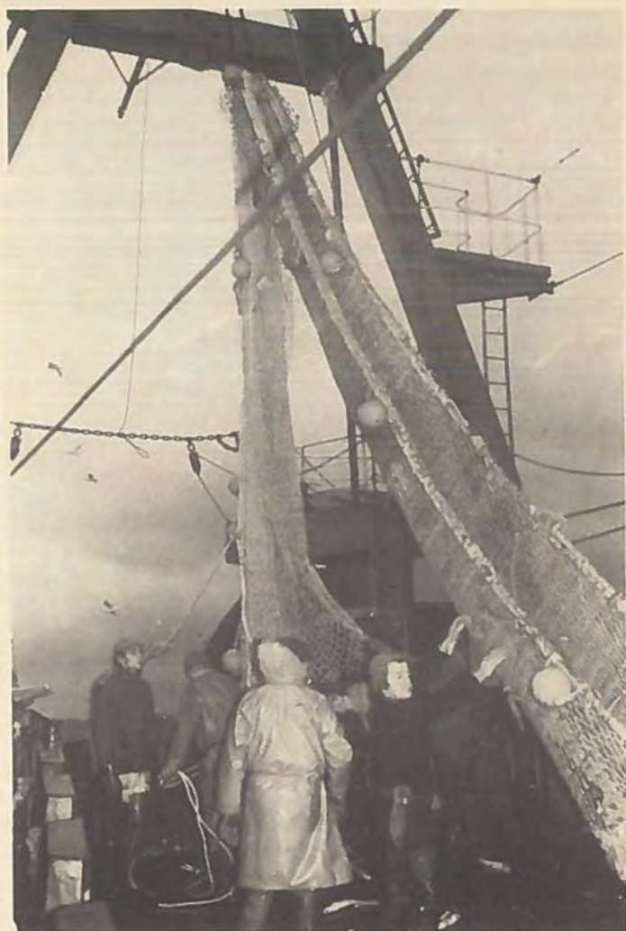
Fransk hæktrawler, trawlet løftet for inspektion af pose.
