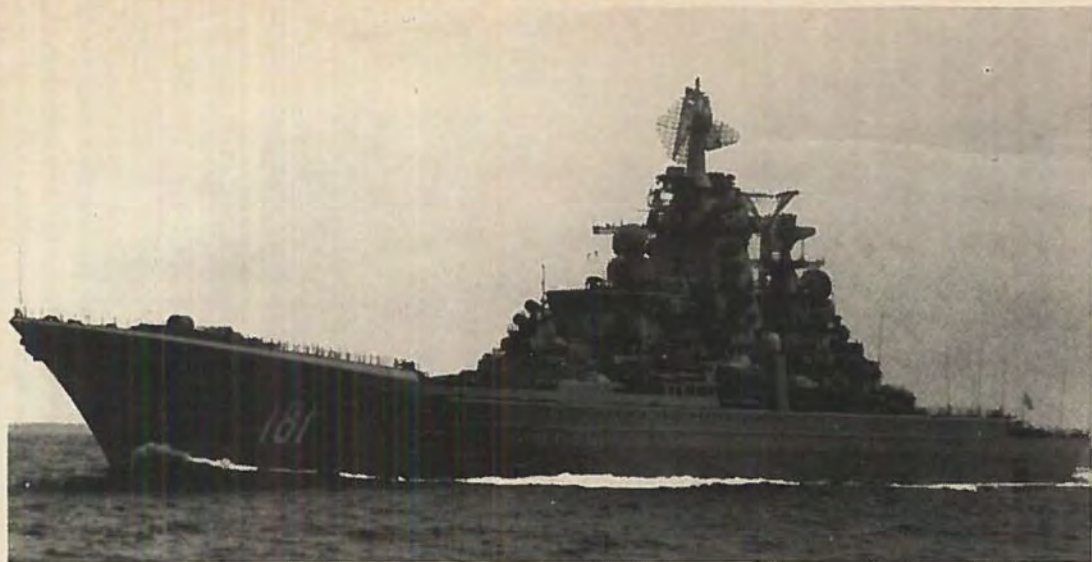
KIROV set fra en forlig vinkel. Hele forskibet må formodes at være optaget af de under dækket indbyggede missilsystemer. Bemærk køjerne, der er usædvanlig i vestlige krigsskibe af nyere dato.
