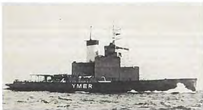
Isbryderen YMER, som foretager sejllads i Polarhavet 1980. Bygget ved Wärtsilä, Helsingfors 1976-77 som sidste i en klasse af 3 isbrydere, der er søsterskibe til den finske URHO-klasse. Displacement 7900 tons.
