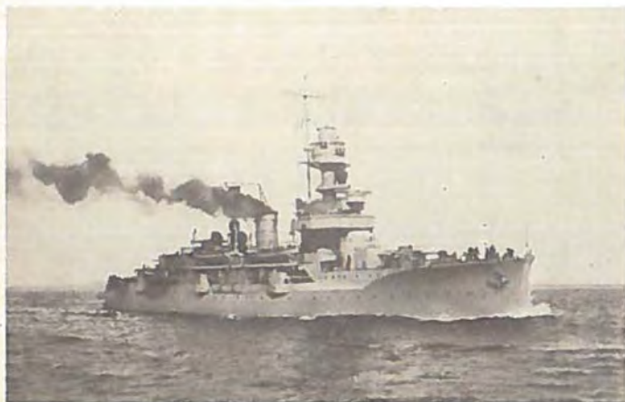
NIELS IUEL efter ombygningen i 1936, hvor den oprindelige tre-bensmast erstattedes af en artillerimast med central-sigte.
