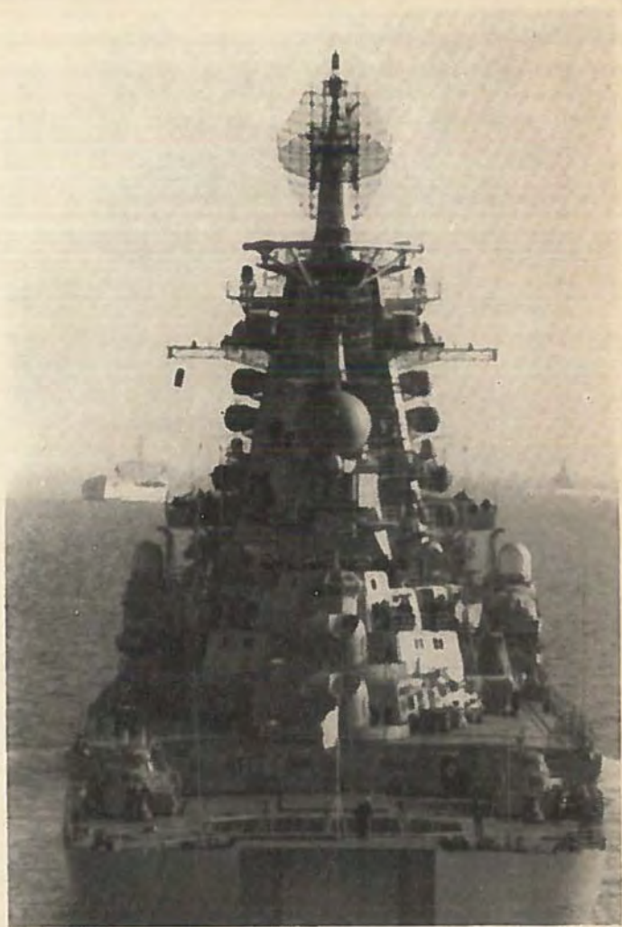
KIROV set agtenfra. Bemærk porten i hækken til udsætning af VDS-sonarsystemet.
