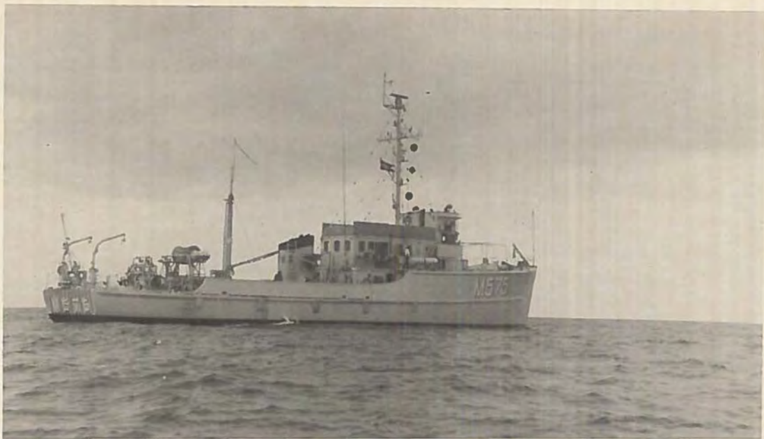
Ministrygeren GULDBORGSUND. Bemærk overbygningen som er større end for de andre enheder af klassen. Opmålings- signalerne er højst.
