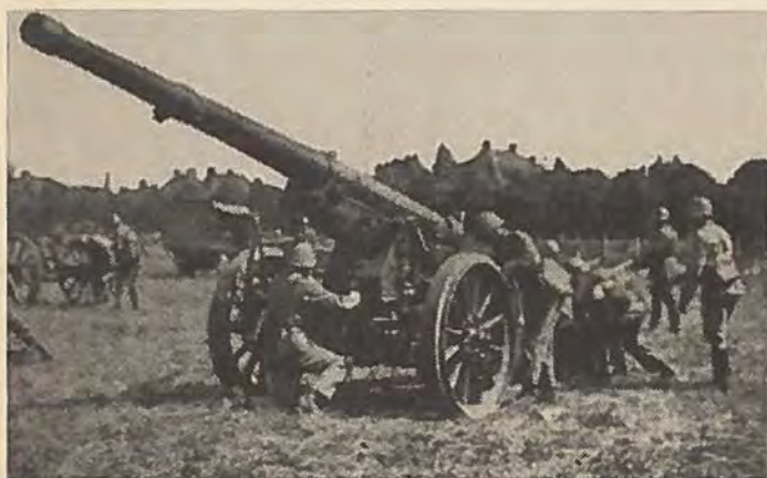
(Foto: Vor hær i krig og fred) 10,5 cm tung kanon under klargøring. Røret er så langt og tungt, at det ikke kan gøres skudklar på lavetten.
