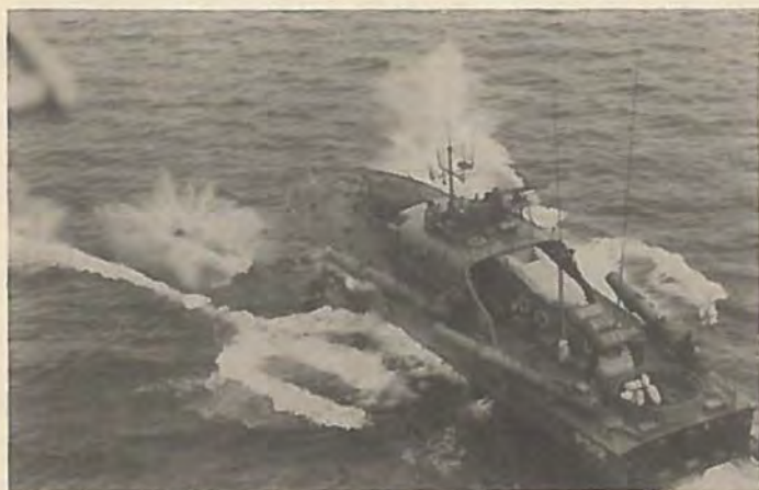
Torpedobåden SØBJØRNEN i torpedobådskonfiguration med 4 torpedorør og een 40 mm kanon. Billedet viser affyring af en torpedofuldsalve.
