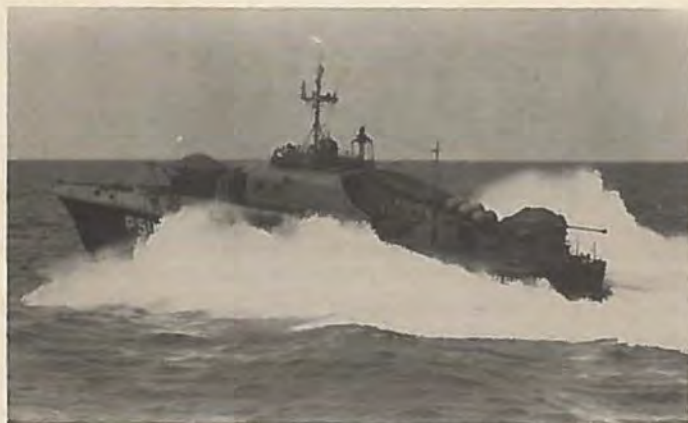
Torpedobåden SØRIDDEREN med to 40 mm kanoner og 2 torpedorør. (Foto SVN)
