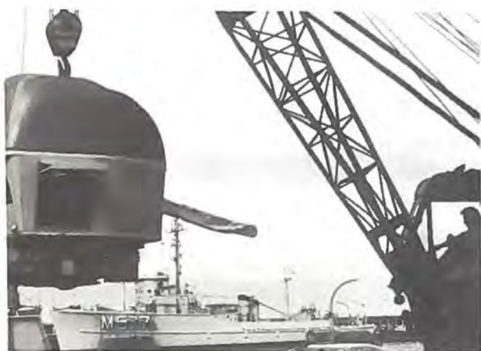
Fra flådestation Korsør. Udskiftning af en 40 mm pjece i et bevogtningsfartøj.
