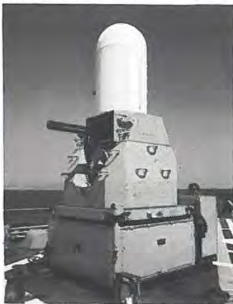
PHALANX system med egen søgeradar, målfølgeradar og kanon.
