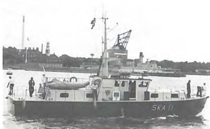
Opmålingsfartøjet SKA 11. Dette er et af de nyeste opmålingsfartøjer udstyret med moderne opmålingsudstyr til automatisk dataindsamling.
