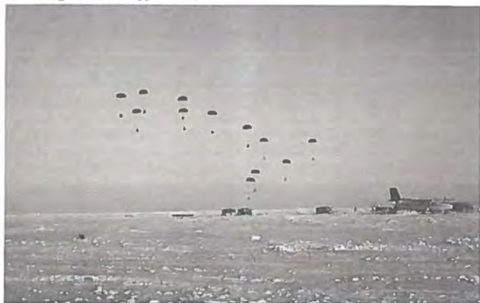
Brændstofforsyning til FRAM I. 16 faldskærme med hver 4 tromler nedkastes fra en C-130 i 1200 fods højde. (Foto: Yngve Kristoffersen).
