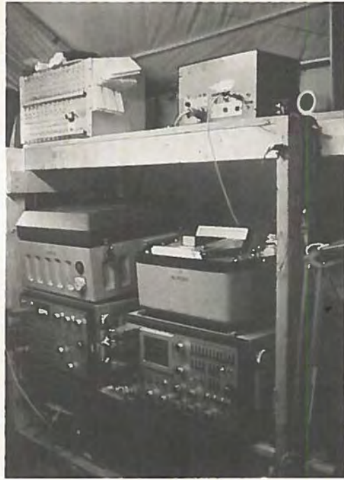
Første seismiske refleksionseksperiment i Polhavet, udført i fuld skala. Billedet viser VHF modtager og dataudstyr for registrering af seismiske reflektionsdata fra en 20 kanals 2 km. lang føler. Som lydkilde blev anvendt en luftkanon nedsænket i havet.
