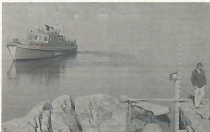
Opmålingsfartøjet SKA 6 er her henne for at kontrollere en selvregistrerende vandstandsmåler opsat i den grønlandske skærgård.
