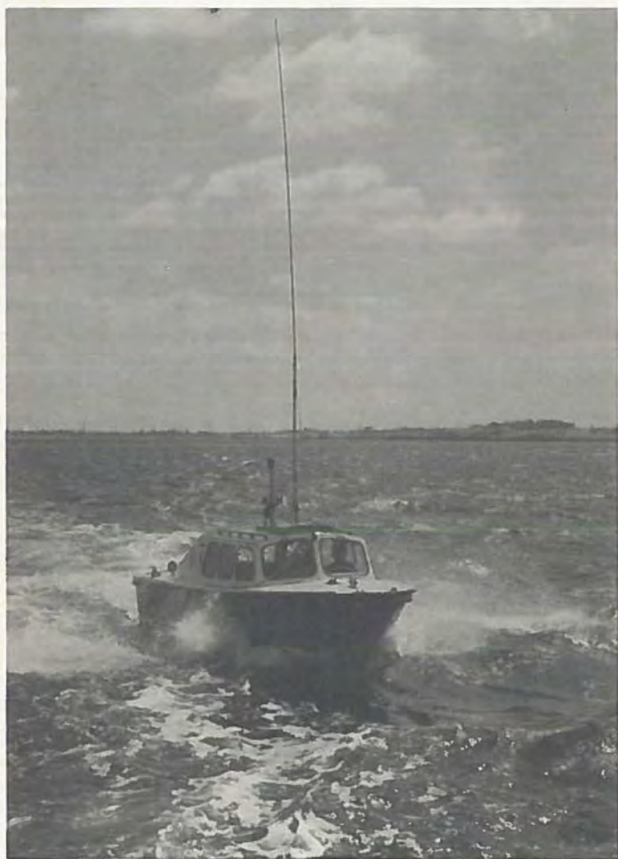
En opmålingsmotorbåd af O-bådstypen under opmåling i danske farvande. Båden her er specielt udrustet med en bambusmast, hvorpå er anbragt en antenne til positionsbestemmelsessystemet.
