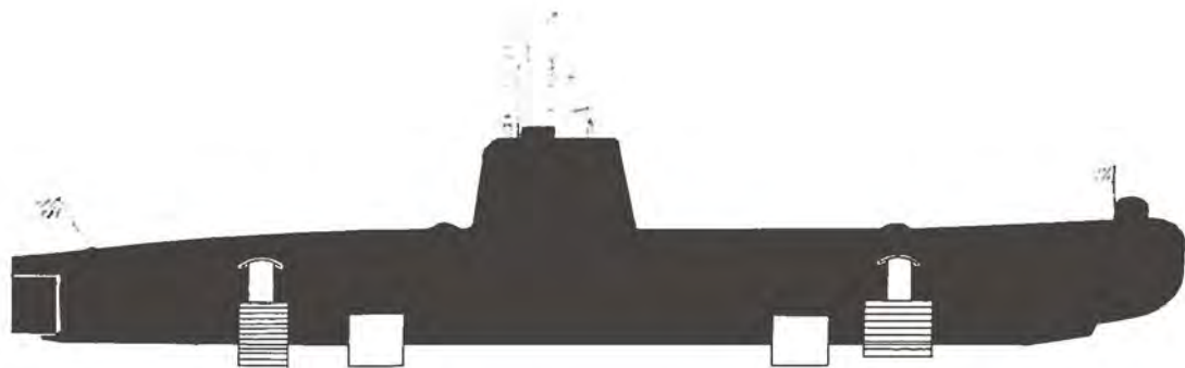
Fig. 1. Skitse af SPÆKHUGGEREN opstillet som museumsbåd på betonfundament og med adgangsveje gennem trykskroget i styrbords side.
