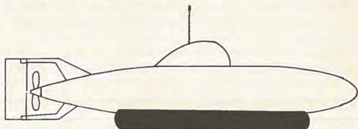
Fig. 4. (Fra Ubåde gennem 75 år). Den tyske miniubåd SEETEUFEL fra anden verdenskrig var forsynet med kørselsbælter så båden selv kunne bevæge sig fra land ud i vandet. Båden konstrueredes kun i et eksemplar i 1944. Deplacementet var på ca. 20 tons. Fremdrivende benzinmotor/elmotor (80/30HK) der muliggjorde overflade-fart på ca. 10 knob neddykket. Rækning ca. 300 sømil. Oplysninger om dette projekt kom Sovjetunionen i hænde i 1945.
